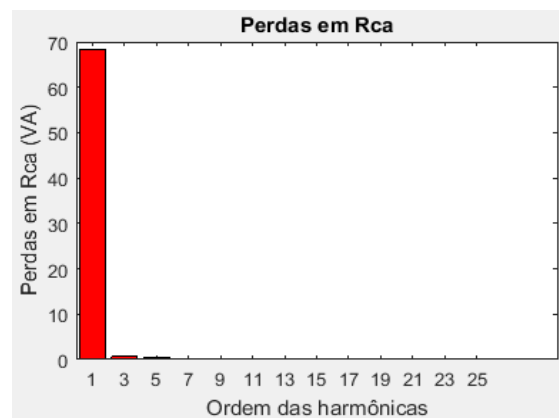
Figura 107 - Perdas elétricas para as distorções harmônicas verificadas no transformador de 225KVA alimentadora de cargas comerciais, no período da madrugada, fase C. Fonte: Autores
