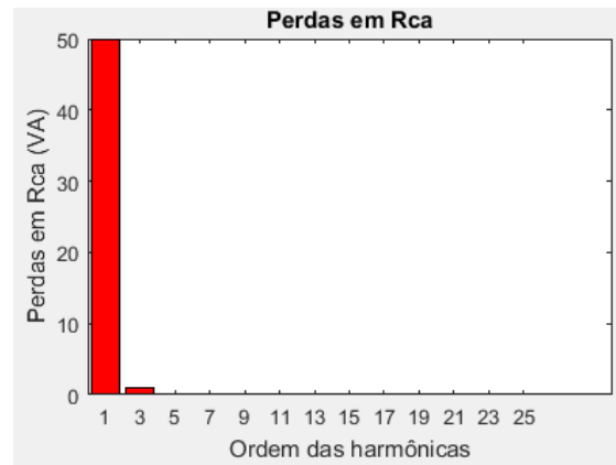
Figura 105 - Perdas elétricas para as distorções harmônicas verificadas no transformador de 225KVA alimentadora de cargas comerciais, no período da madrugada, fase A Fonte: Autores
