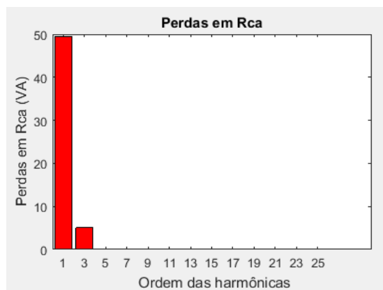
Figura 55 - Perdas elétricas para as distorções harmônicas verificadas no transformador de 45 KVA alimentadora de cargas residenciais, as 21:00, neutro. Fonte: Autores
