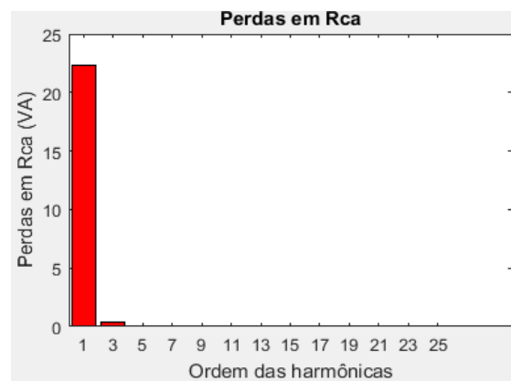
Figura 106 - Perdas elétricas para as distorções harmônicas verificadas no transformador de 225KVA alimentadora de cargas comerciais, no período da madrugada, fase B Fonte: Autores
