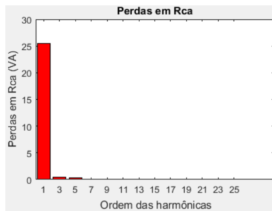
Figura 42 - Perdas elétricas para as distorções harmônicas verificadas no transformador de 45 KVA alimentadora de cargas residenciais, as 12:00, fase C. Fonte: Autores
