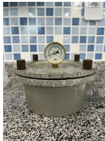
Figura 13 - panela de pressão utilizada para completar a reação de polimerização
