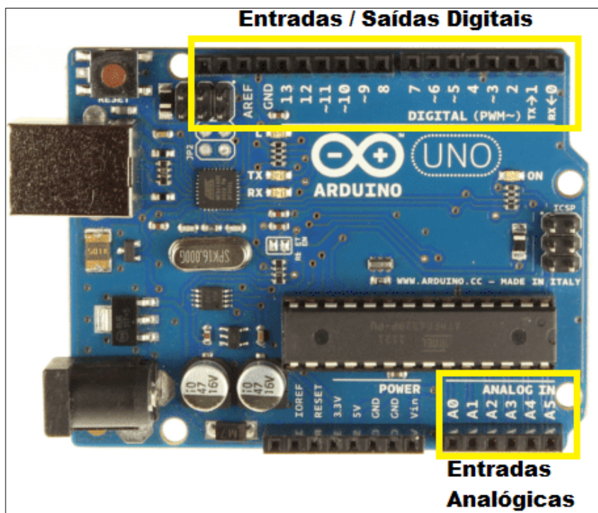
Figura 8 – Entradas e Saídas da placa Arduino UNO Fonte: Souza (2013)
