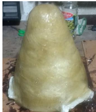
Figura A 31 - Aplicação da resina com fibra de vidro sobre o molde.
