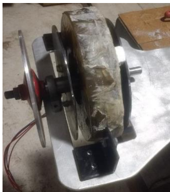
Figura A 71 – Arranjo das peças da turbina em suas respectivas posições de montagem.
