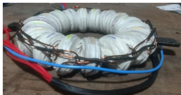
Figura A 56 - Conclusão do fechamento das bobinas.
