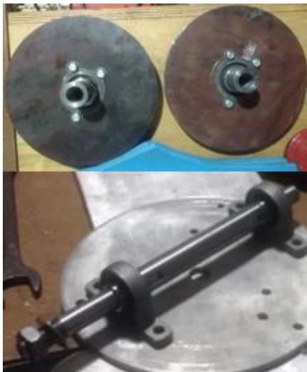
Figura A 36 - Montagem do Sistema de coplamente dos rotores do gerador e mancais no eixo de acoplamento.
