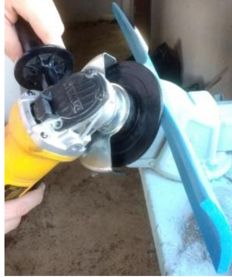
Figura A 15 - Acabamento nas arestas utilizando uma lixadeira de 4" com disco de lixa para madeira.
