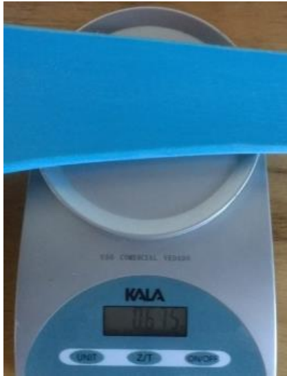
Figura A 16 - Pesagem das pás para ajustes de balanceamento.
