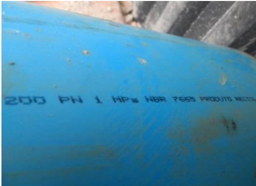
Figura A 12 - Tubo utilizado na fabricação - PVC, d.: 200 mm, esp.: 10 mm.
