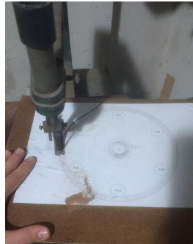
Figura A 64 - Recorte das posições dos ímãs no molde.
