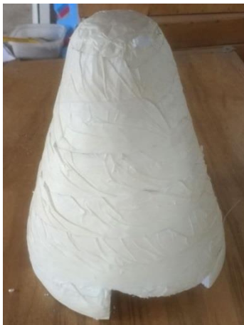
Figura A 30 - Molde do nariz da turbina.
