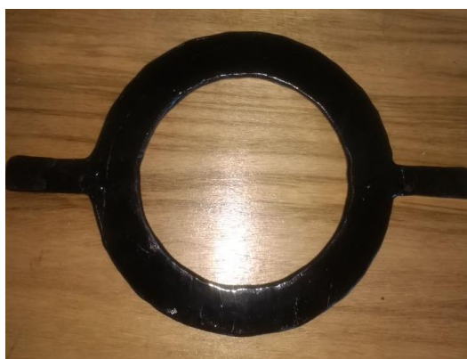
Figura A 48 - Entreferro do estator finalizado.
