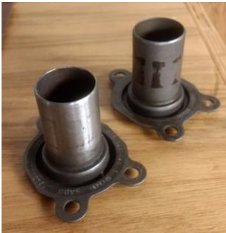
Figura A 34 - Flange de Fixação dos rotores do gerador.
