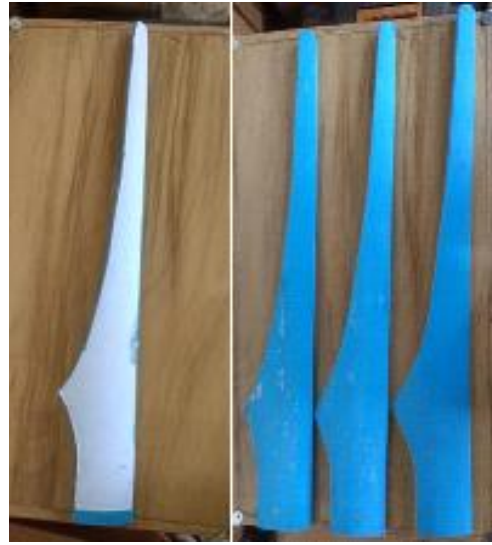
Figura A 17 - Hélices cortadas e acabadas.
