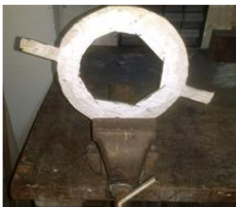
Figura A 44 - Recorte e acabamento interno do estator.
