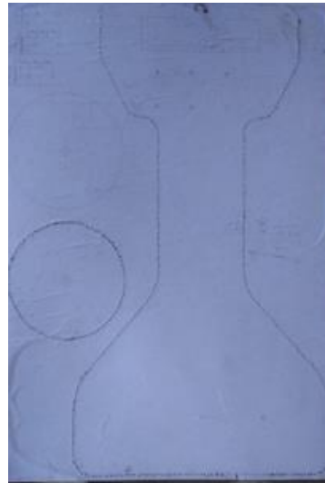
Figura A 19 - Colagem do molde construtivo do leme e rotor da turbina na chapa de alumínio.
