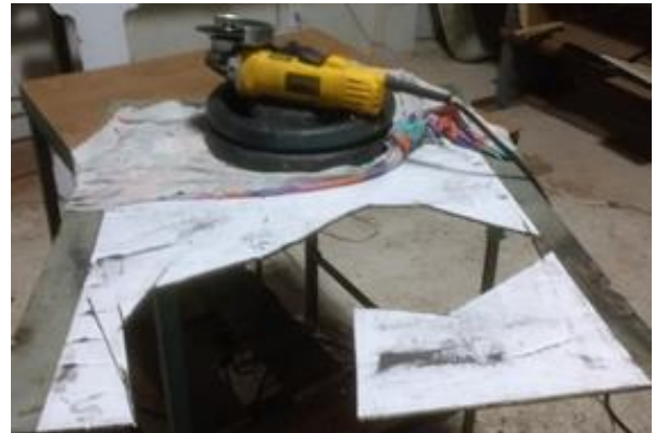
Figura A 41 - Fabricação do estator e rotores com a esmerilhadeira de 4" e disco de corte rápido.
