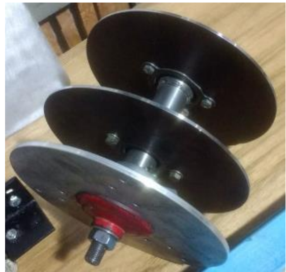
Figura A 37 - Montagem do Sistema de coplamente entre os rotores do gerador e o rotor da turbina.
