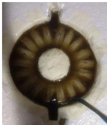
Figura A 60 - Envolvimento do estator em resina.
