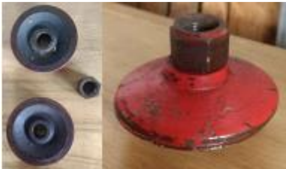
Figura A 32 - Flange de fixação do rotor da turbina.
