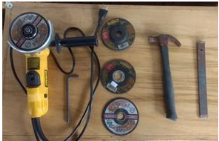
Figura A 39 - Ferramentas utilizadas para fabricação do estator e rotores.
