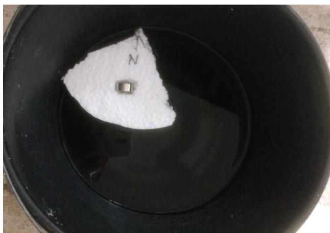
Figura A 66 - Identificação da polaridade do imã.
