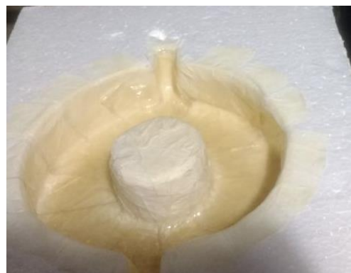
Figura A 58 - Isolamento do molde com fita crepe.
