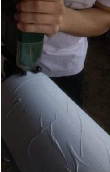
Figura A 14 - Recorte das pás no tubo utilizando a serra tico-tico e serra para madeira.
