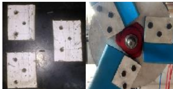
Figura A 22 - Presilhas de fixação das pás da turbina.
