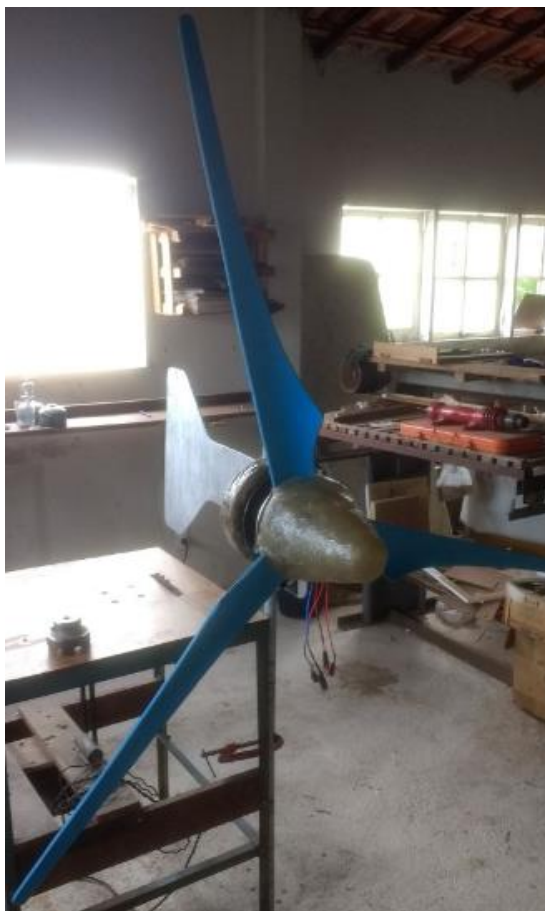
Figura A 74 – Montagem final da turbina eólica.
