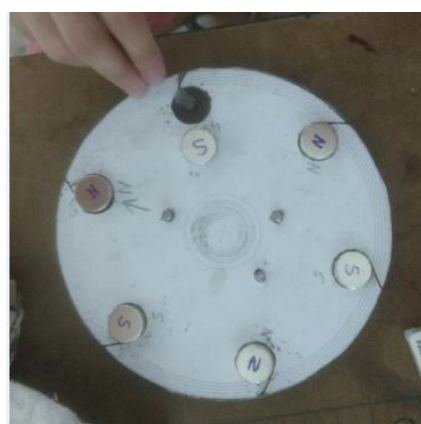
Figura A 68 - Aplicação de cola no rotor.
