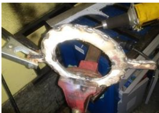
Figura A 46 - Soldagem das partes do estator.
