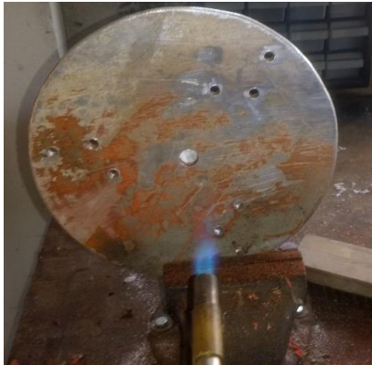
Figura A 23 - Remoção da tinta do rotor da turbina.
