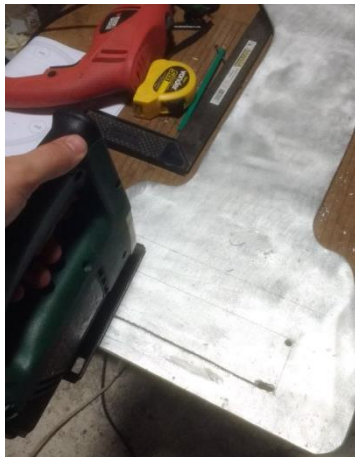
Figura A 27 - Recorte para posicionamento do gerador.
