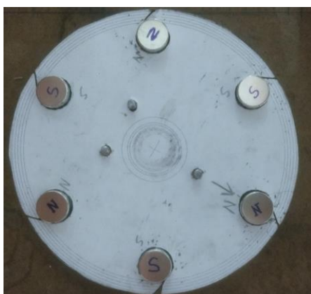
Figura A 69 - Colagem dos ímãs no rotor do gerador.
