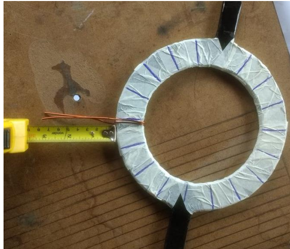
Figura A 52 - Marcação das posições das bobinas.
