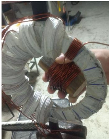
Figura A 53 - Enrolamento das bobinas do estator.
