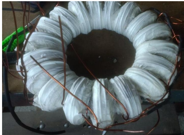
Figura A 54 - Enrolamento do estator finalizado.
