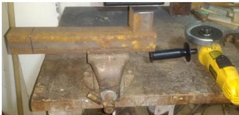
Figura A 49 - Fabricação dos suportes do estator.
