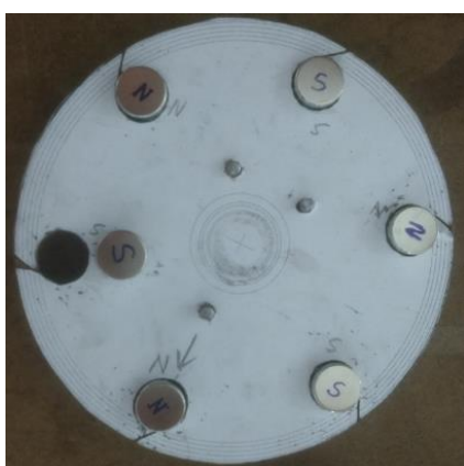
Figura A 67 - Posicionamento dos ímãs no molde do rotor.
