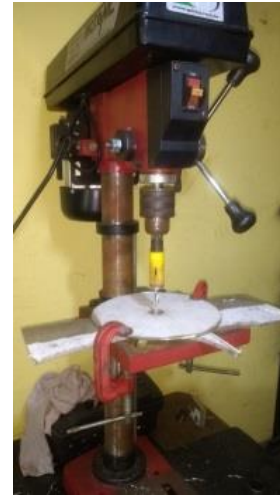
Figura A 21 - Perfuração do rotor da turbina para fixação das hélices e eixo.
