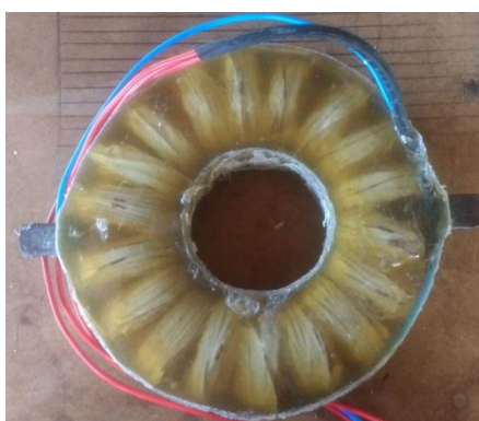
Figura A 61 - Estator finalizado.
