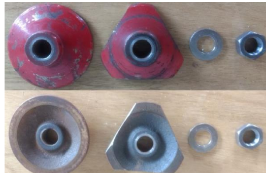
Figura A 33 - Flange de fixação do rotor da turbina.
