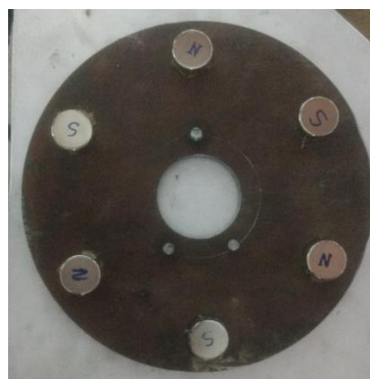
Figura A 70 - Remoção do molde de colagem dos ímãs no rotor.
