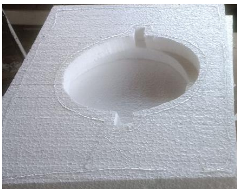
Figura A 57 - Confecção do molde em isopor para envelopamento do estator.
