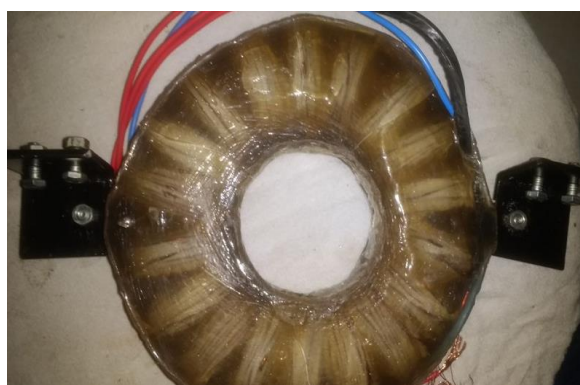
Figura A 62 - Fixação dos suportes do estator.
