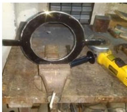
Figura A 47 - Acabamento nas bordas interna e externa do estator com a lixadeira e disco de desbaste.
