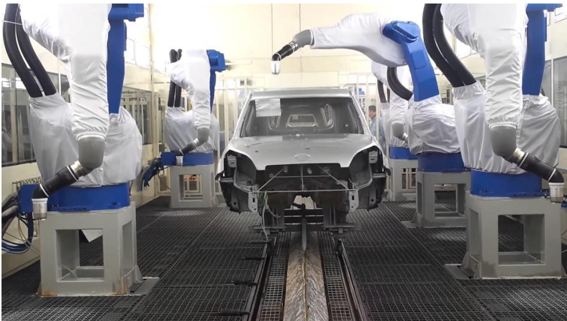
Figura 26 Pistola para pintura conectada à braços robóticos.
