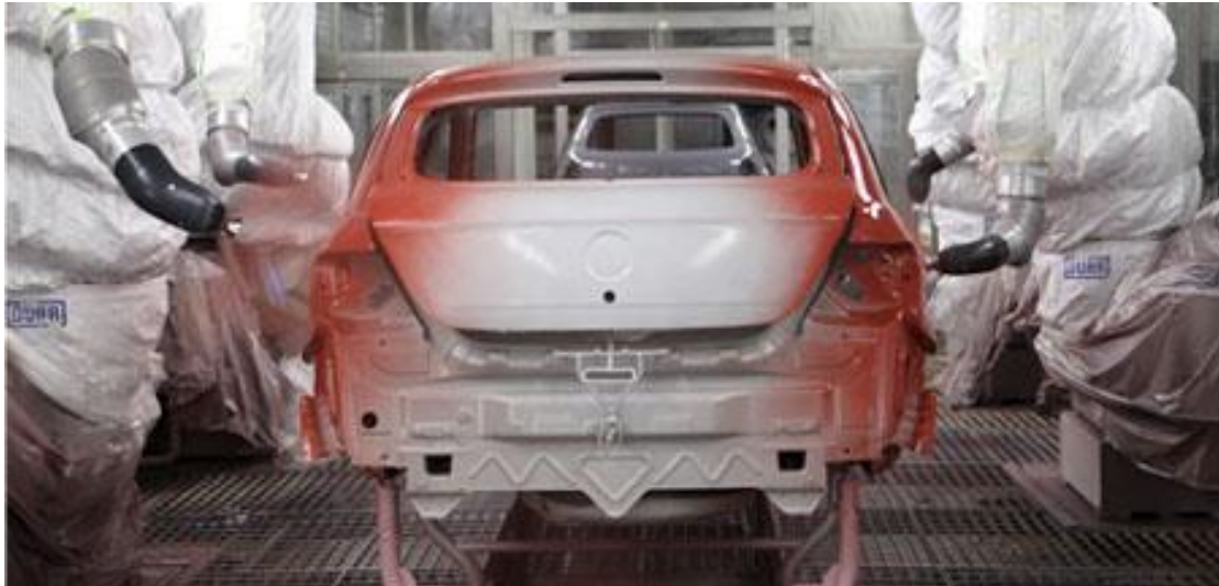
Figura 41 Aplicação da tinta base automatizada.
