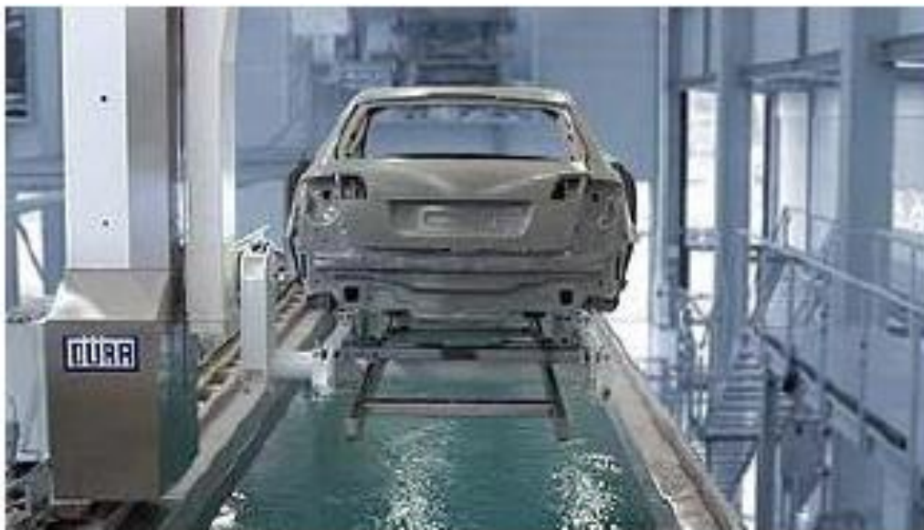
Figura 34 Enxágue pós eletrodeposição de tinta.
