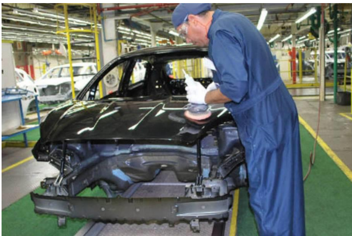
Figura 44 Seção de acabamento após a pintura.
