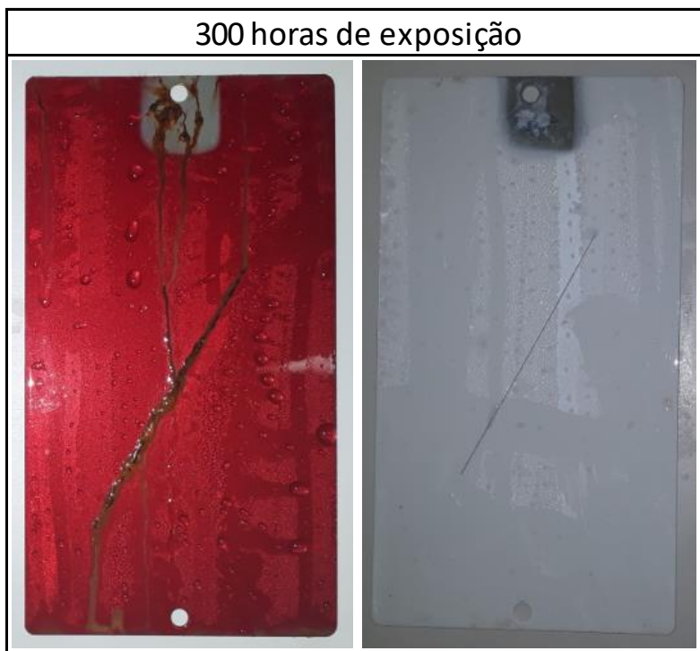
Figura 56 Aspecto superficial de amostras em aço carbono e aço HDG após exposição a atmosfera salina durante 300 horas.
