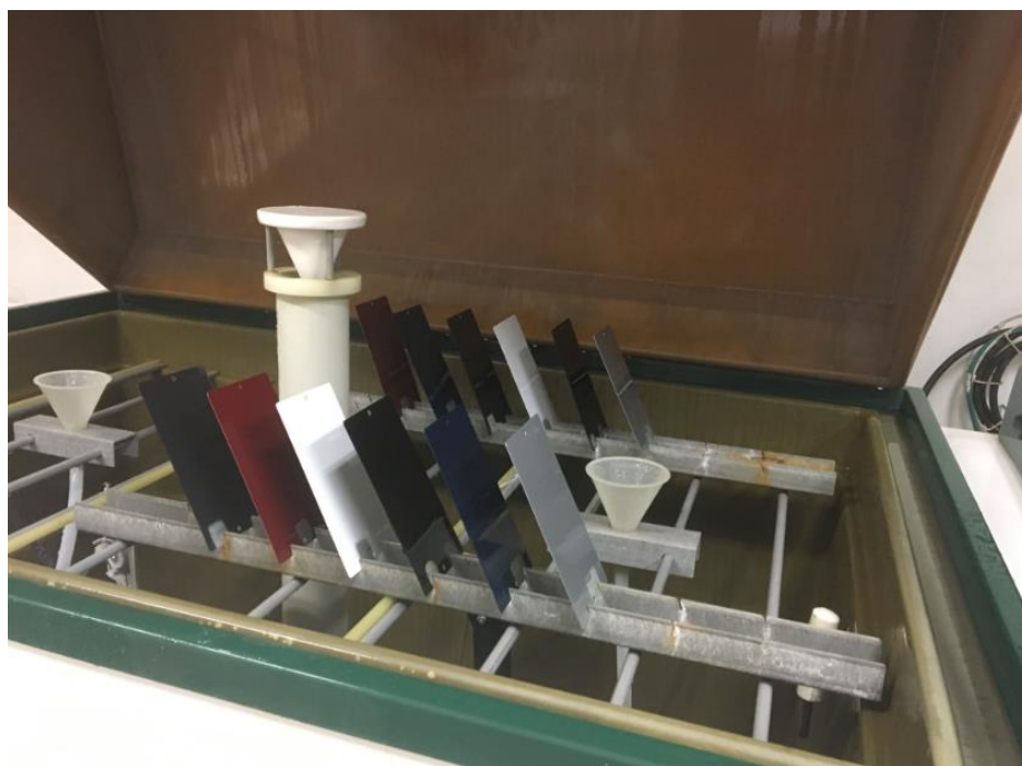
Figura 51 Posicionamento dos corpos de prova na câmara de névoa salina.
