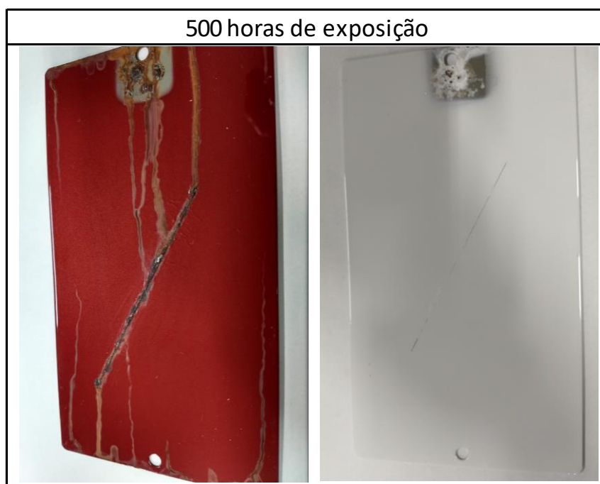
Figura 58 Aspecto superficial final de amostras em aço carbono e aço HDG após exposição a atmosfera salina durante 500 horas.
