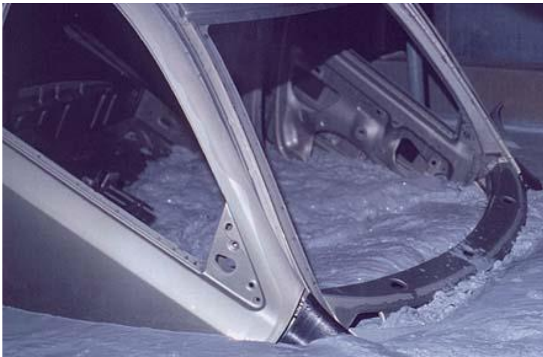
Figura 23 Processo de revestimento de tinta por eletrodeposição catódica.
