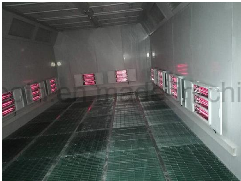
Figura 40 interior de uma estufa para cura/secagem de tinta
