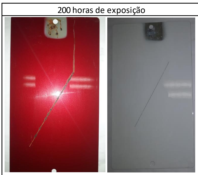
Figura 55 Aspecto superficial de amostras em aço carbono e aço HDG após exposição a atmosfera salina durante 200 horas.
