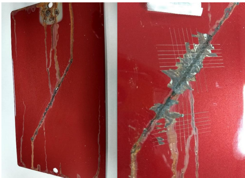
Figura 60 Amostra em aço carbono antes e após ensaio, respectivamente, para classificação do grau de adesão da película de pintura protetiva aplicada.
