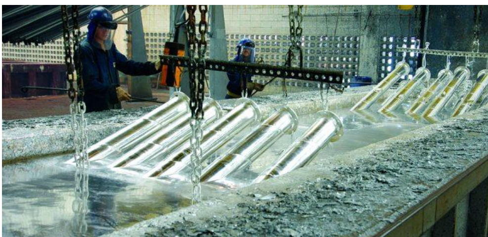
Figura 18 Barra de aço para armadura de concreto galvanizada por imersão à quente.
