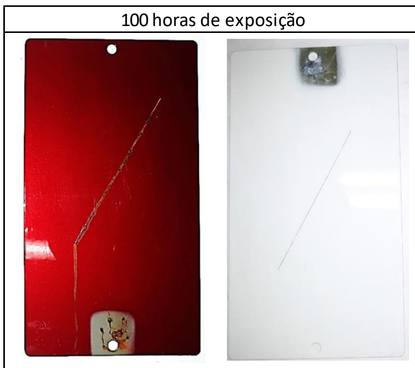
Figura 54 Aspecto superficial de amostras em aço carbono e aço HDG após exposição a atmosfera salina durante 100 horas.
