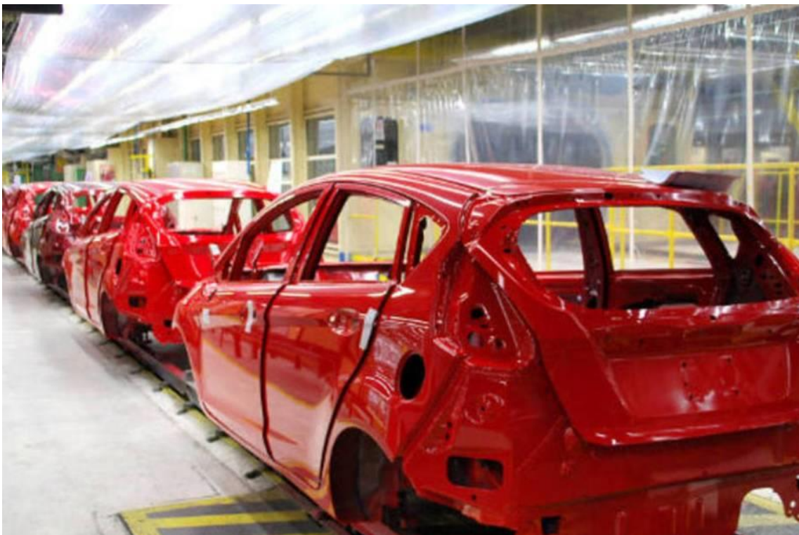
Figura 42 Superfície das carrocerias após a aplicação do verniz.
