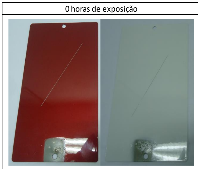
Figura 53 Aspecto superficial de amostras em aço carbono e aço HDG no início do ensaio em camera salt spray.
