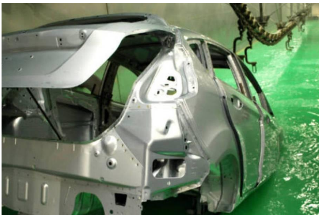
Figura 19 Carroceria em um banho de imersão para receber cristais de fosfato.
