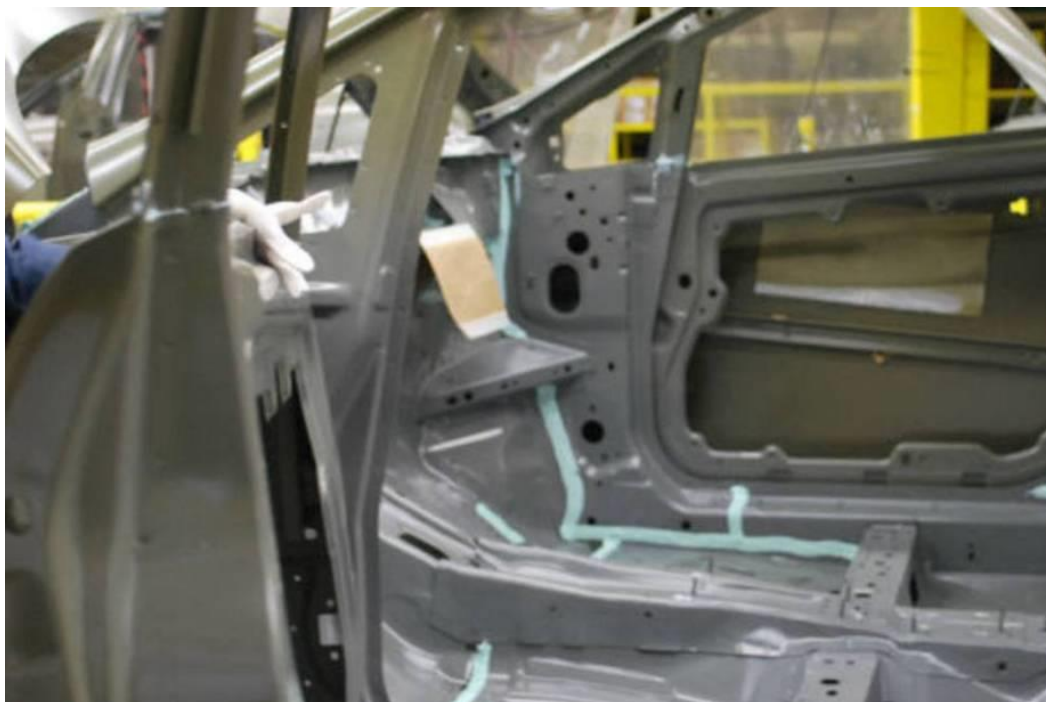
Figura 36 Massa de vedação aplicada ao interior do veículo.
