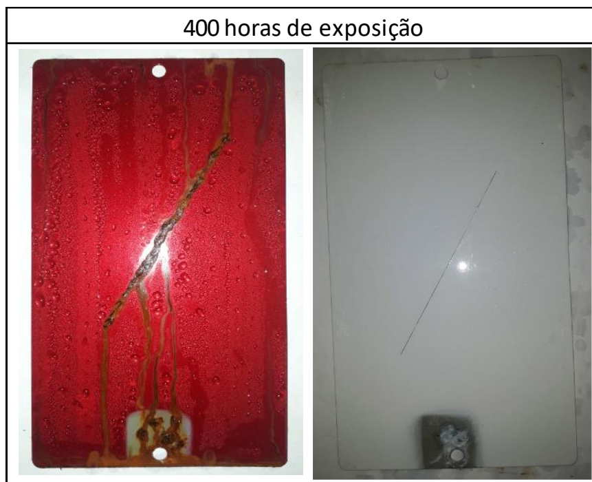
Figura 57 Aspecto superficial de amostras em aço carbono e aço HDG após exposição a atmosfera salina durante 400 horas.
