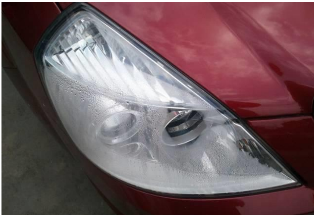
Figura 17 Formação de filme de líquido no interior de um componente automotivo.
