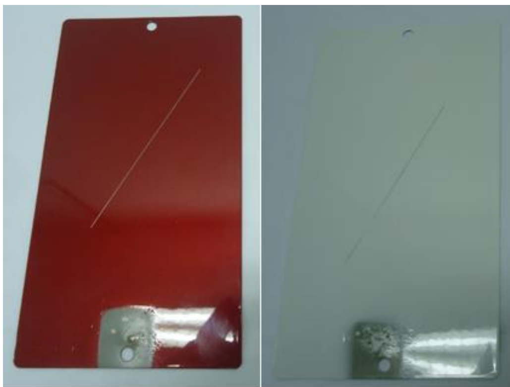
Figura 50 Amostras após dano mecânico por ferramenta com ponta de carbeto de tungstênio.
