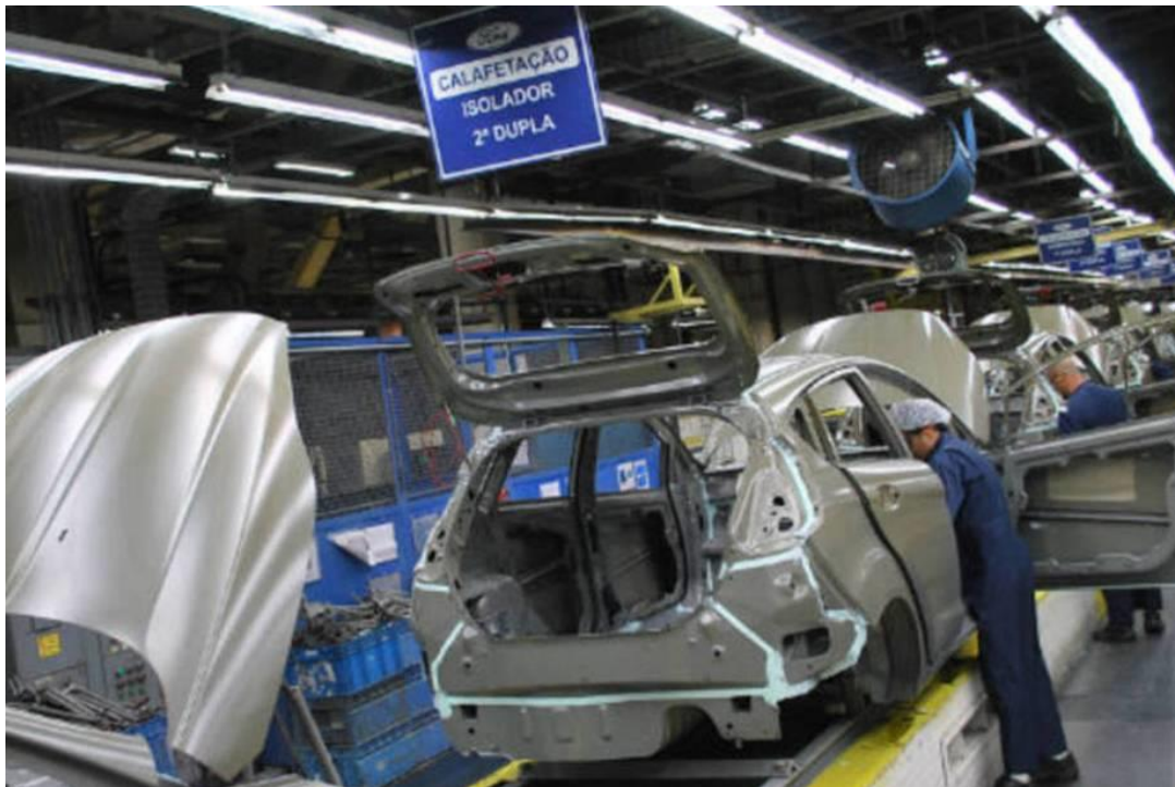
Figura 35 Funcionários aplicando materiais de vedação na carroceria.
