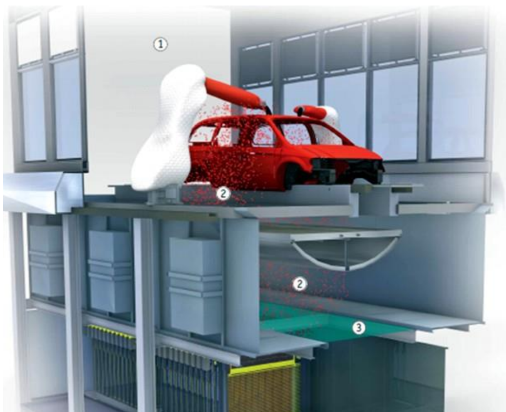
Figura 39 Esquema de filtragem do ar na câmara de pintura e acolhimento de overspray.
