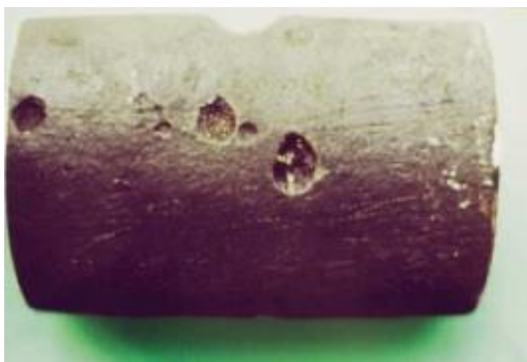
Figura 11 Metal com corrosão do tipo alveolar.
