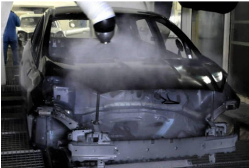
Figura 37 Aplicação do primer, por aspensão, através de braços robóticos.
