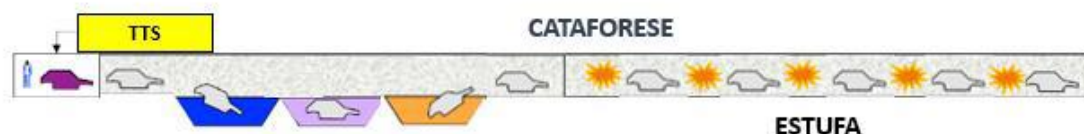
Figura 32 Esquema da sequência do revestimento com cataforese.
