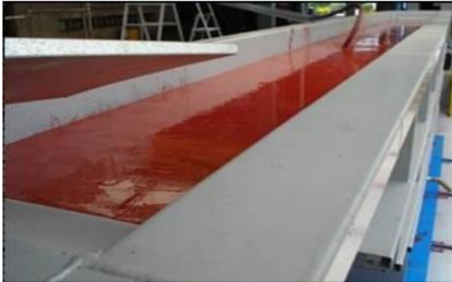
Figura 24 Imersão para pintura sem corrente elétrica.
