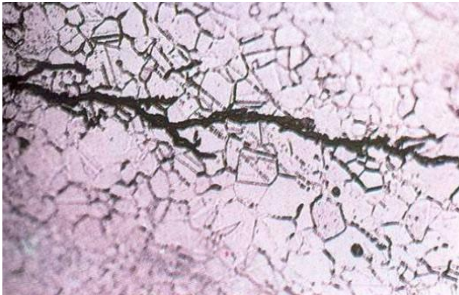
Figura 15 Corrosão do tipo intragranular.
