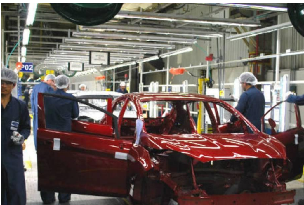
Figura 43 Inspeção da carcaça após a pintura.
