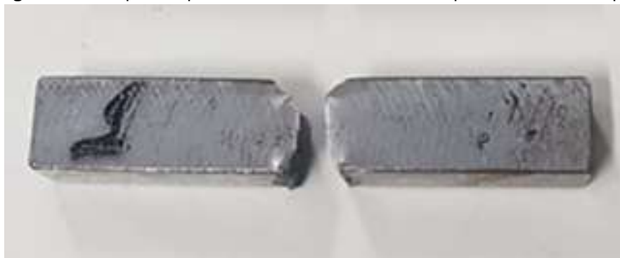
Figura 22 - Corpos de prova do material ASTM A572 após ensaio de charpy.
