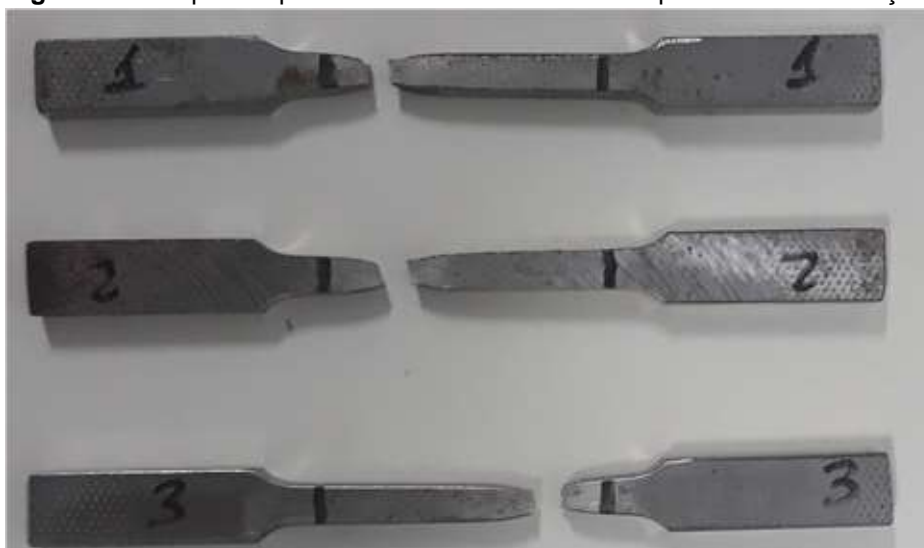
Figura 20 - Corpos de prova do material ASTM A572 após o ensaio de tração.
