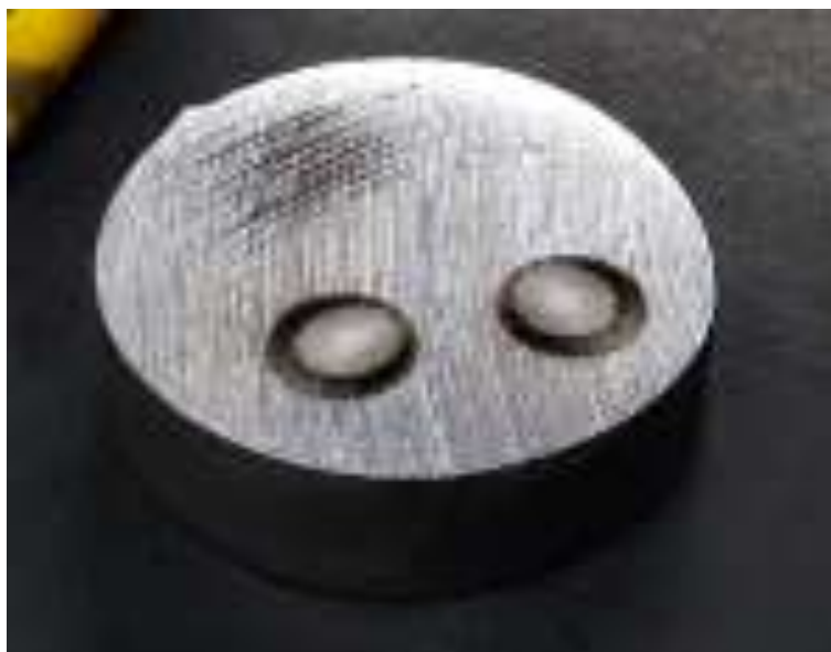
Figura 9 - Corpo de prova para análise de espectrometria óptica do aço carbono ASTM A572 Gr 50.
