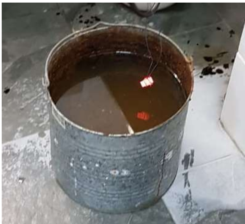
Figura 29 - Amostra sendo submetida ao resfriamento em água.
