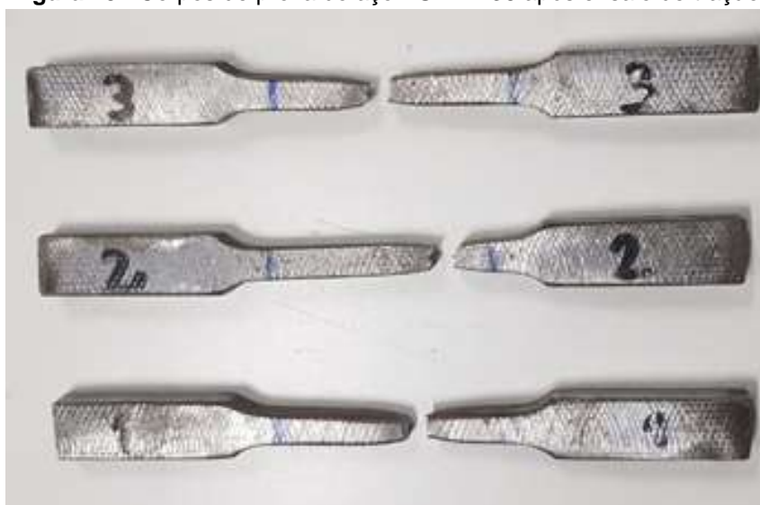
Figura 18 - Corpos de prova do aço ASTM A36 após ensaio de tração.
