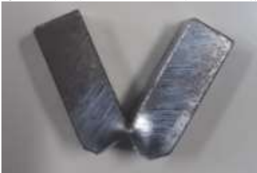
Figura 21 - Corpos de prova do material ASTM A36 após ensaio de charpy.
