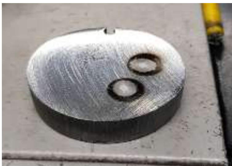
Figura 8 - Corpo de prova para análise de espectrometria óptica do aço carbono ASTM A36.
