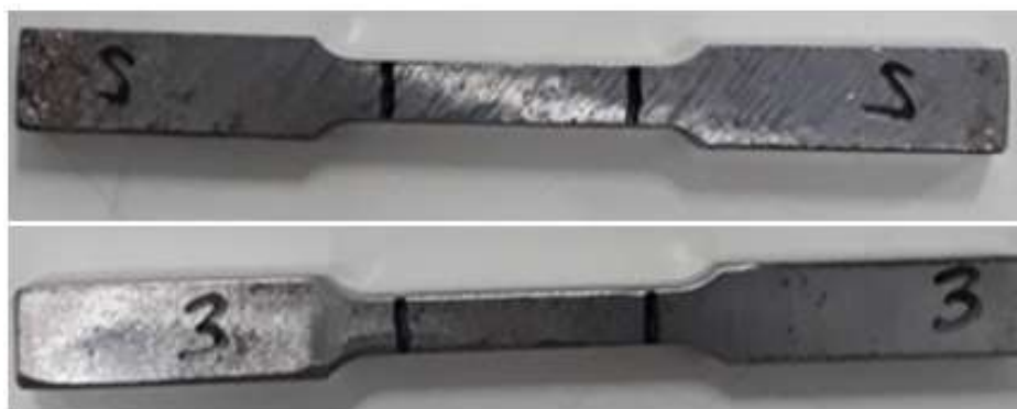
Figura 19 - Corpos de prova do aço ASTM A36 e aço ASTM A572 antes do ensaio de tração.
