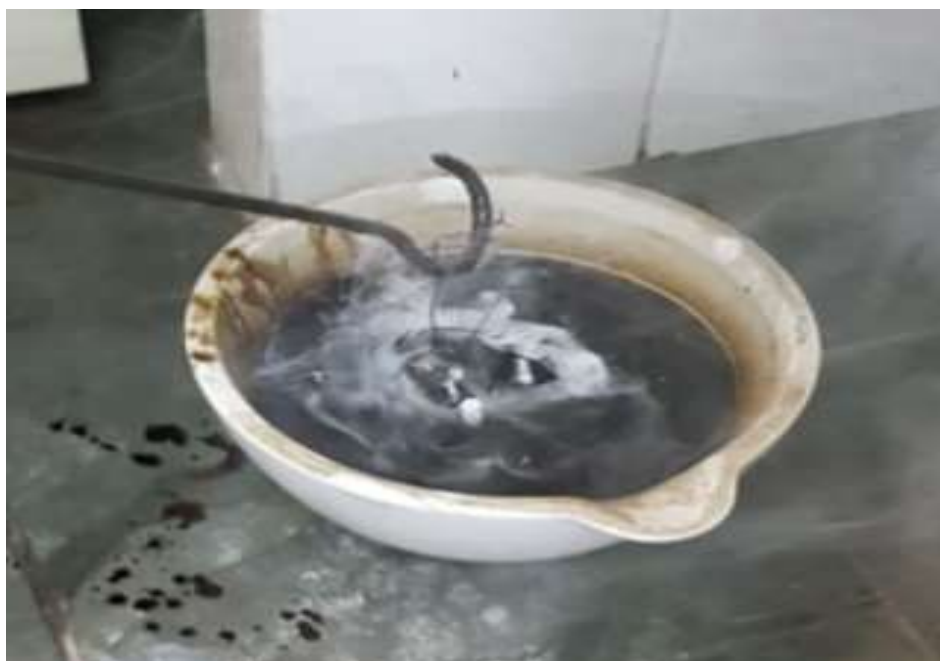
Figura 28 - Amostra sendo submetida ao resfriamento em água (KTALO TN).
