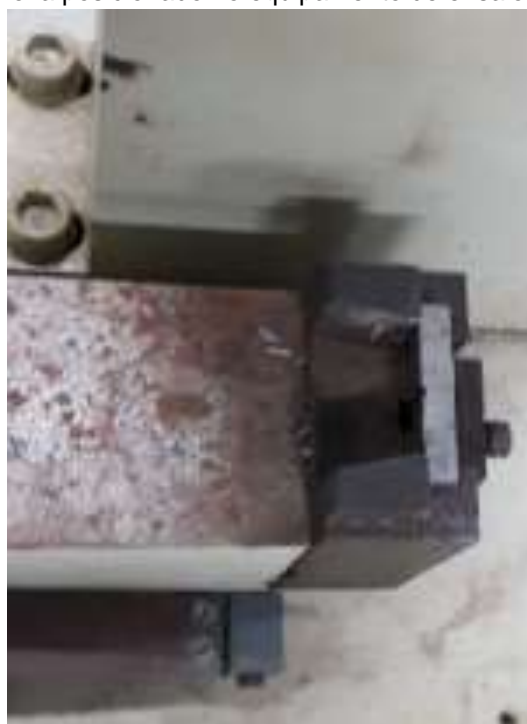
Figura 24 - Corpo de prova posicionado no equipamento de ensaio de charpy Pantec PS30
