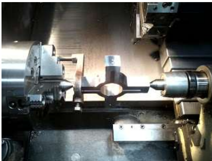
Figura 33: Usinagem de uma cruzeta em aço SAE 8620.
