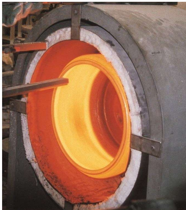
Figura 32: Processo de fundição por centrifugação.
