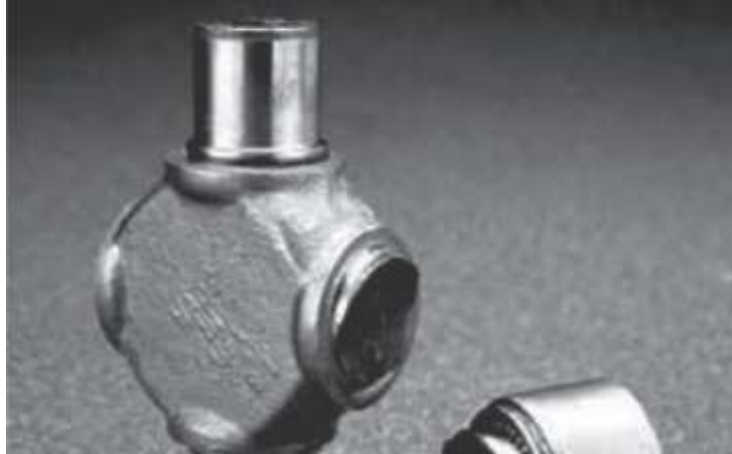
Figura 44 - Junta universal fraturada.
