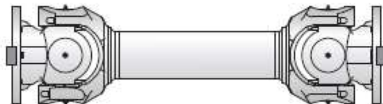
Figura 37: Eixo cardan com tubo e sem curso.
