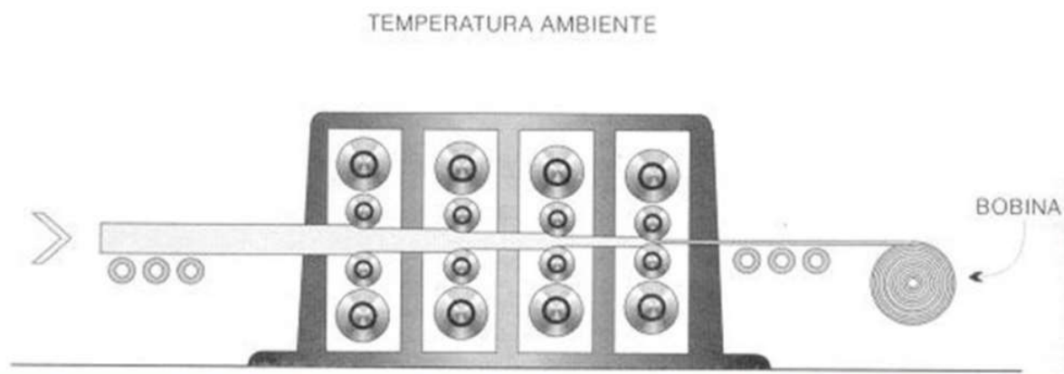
Figura 5: Desenho esquemático do processo de laminação à frio.
