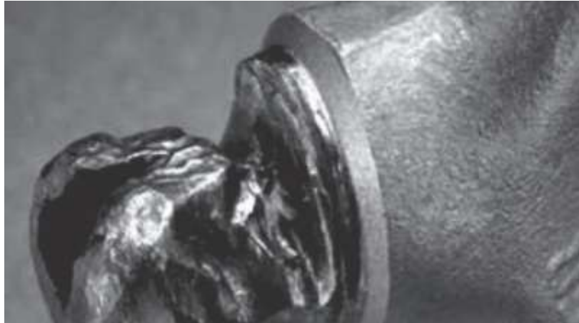
Figura 43 - Cruzeta da junta universal queimada.
