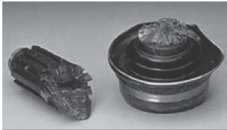
Figura 51 - Fratura nas ranhuras de deslizamento
