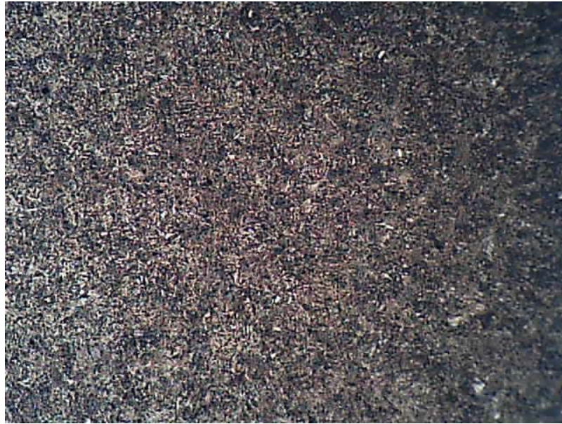
Figura 33 – Microestrutura martensítica. Aumento de 200x
