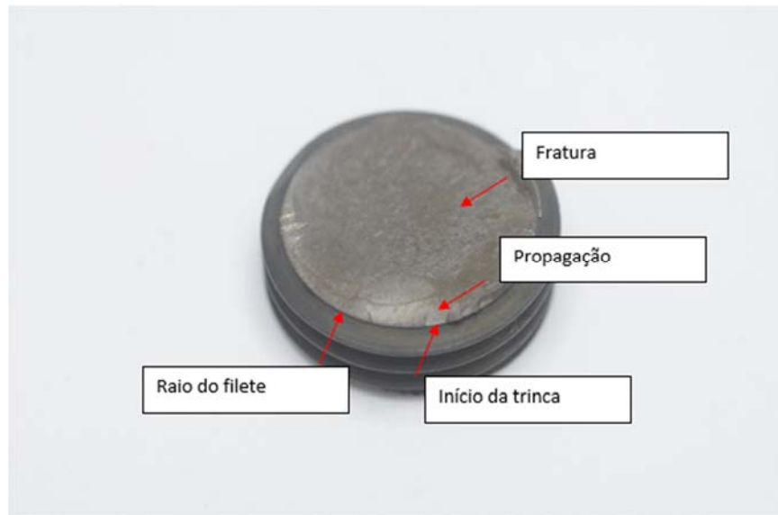
Figura 37 – Superfície da fratura
