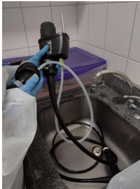
Figura 6 – Teste de estanqueidade (1'10")
