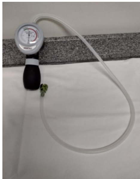
Figura 5 – Manômetro utilizado para o teste de vedação
