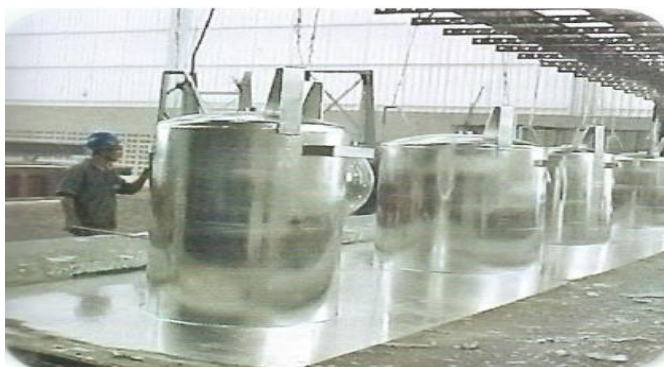
Figura 5: Zincagem por imersão à quente
