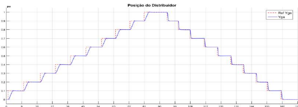
Figura 17 - Oscilografia do Ensaio de Degraus Gradativos do Distribuidor
