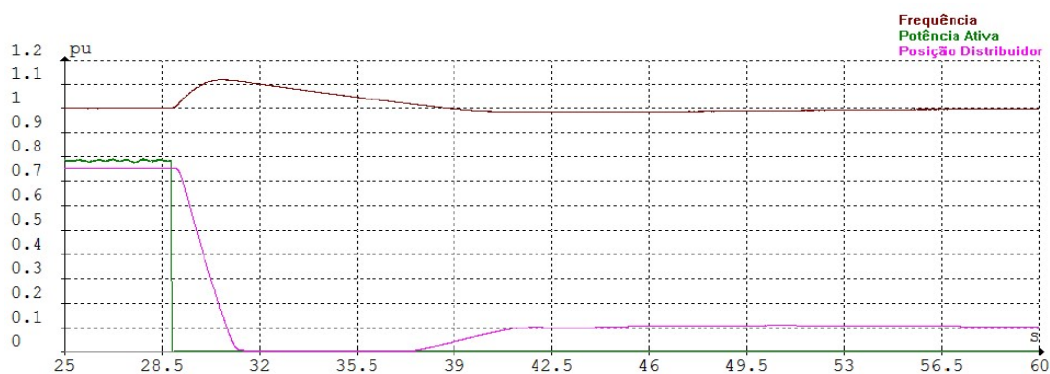
Figura 56 - Oscilografia do Ensaio de Rejeição de Carga à 75% RV novo
