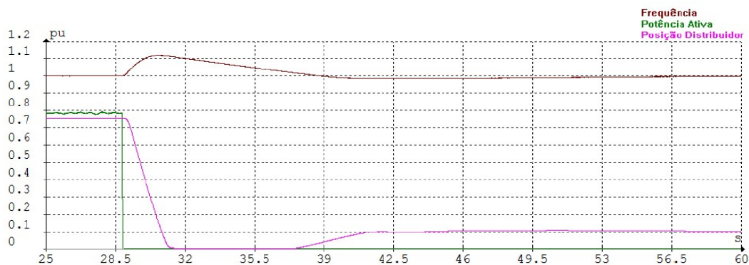
Figura 38 - Oscilografia do Ensaio de Rejeição de Carga à 75%
