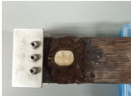
Figura 2- Elemento posicionado na máquina de corte para remoção da superfície oclusal;
