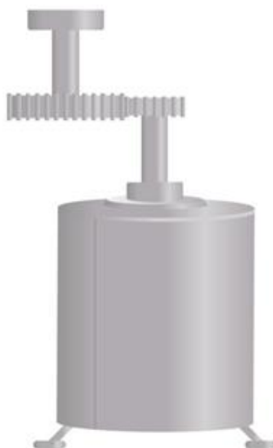
Figura 24 - Gerador e caixa de engrenagens.
