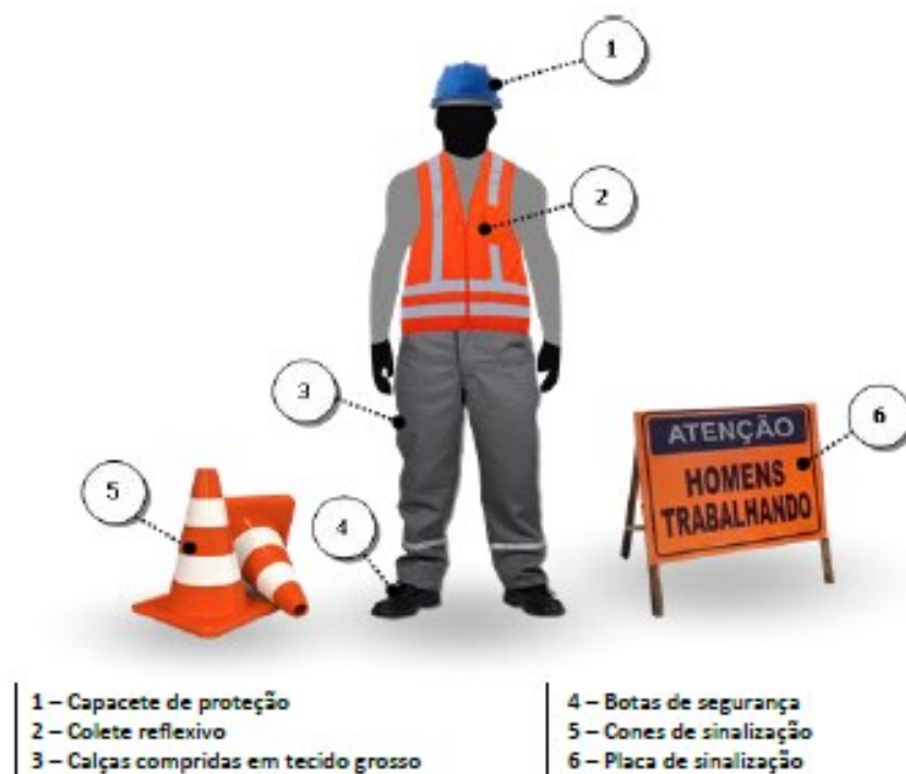
Figura 32- Equipamento de proteção individual e coletivo.
