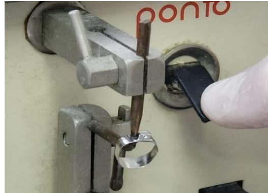
Figura 24: Soldagem do tubo na banda
