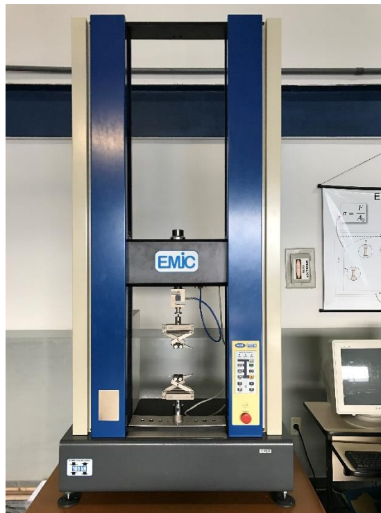
Fotografia 1: Máquina Universal para Ensaio de tração (EMIC).
