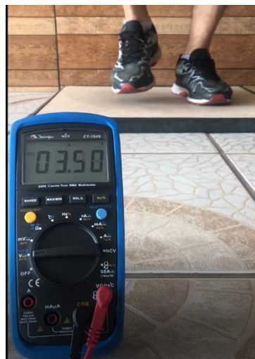
Figura 35- Tensão regulada pelo LTC3588 (autores, 2020)
