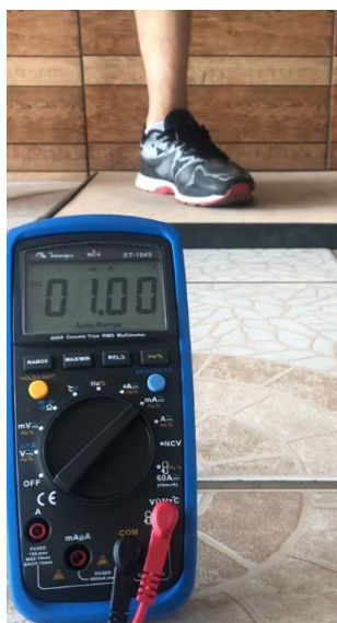
Figura 36- Corrente regulada pelo LTC3588 (autores, 2020)
