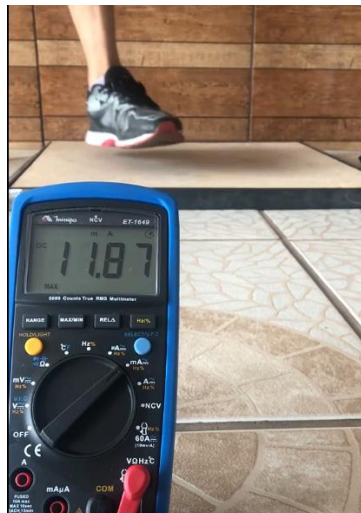
Figura 31- Geração de pico de corrente positiva malha fechada (autores, 2020)
