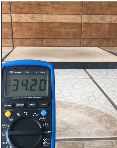
Figura 29- Geração de pico de tensão negativo malha aberta (autores, 2020)
