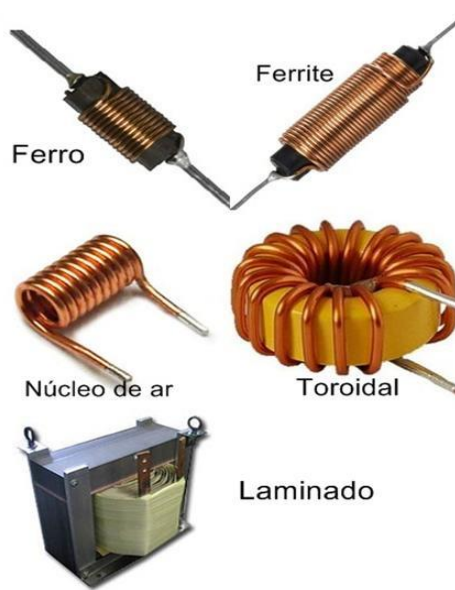
Figura 17- Tipos de núcleo de indutores (mundodaeletrica,s.d)
