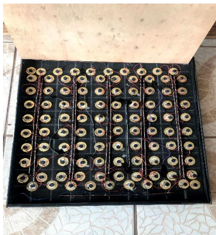
Figura 27- Interno do piso gerador (autores, 2020)
