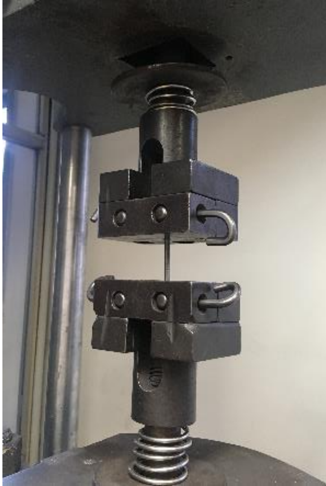
Figura 24 – Corpo de prova fixado para ensaio de tração
