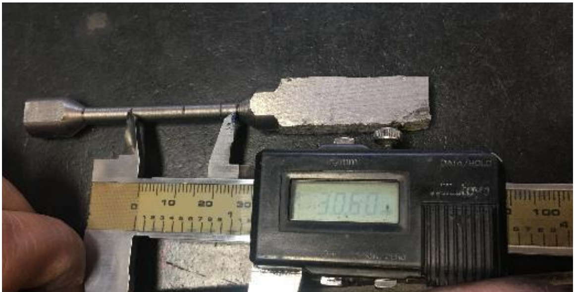
Figura 26 – Medição do comprimento útil do corpo de prova
