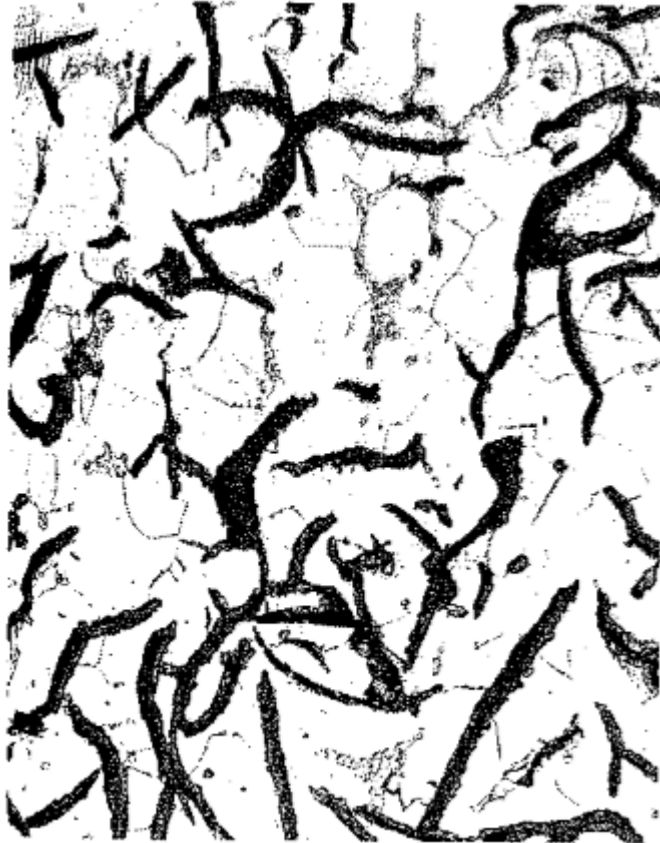
Figura 10 – Microestrutura ferro fundido cinzento.
