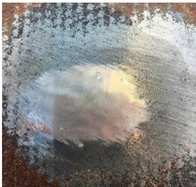
Figura 18 – Ataque químico realizado na superfície da amostra
