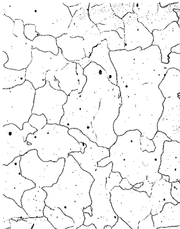
Figura 02 – Ferrita \alpha (ampliação de 90x)
