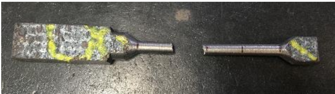
Figura 25 – Corpo de prova fraturado após ensaio de tração
