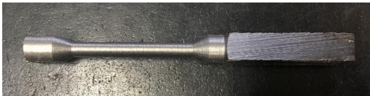
Figura 23 – Corpo de prova usinado padrão
