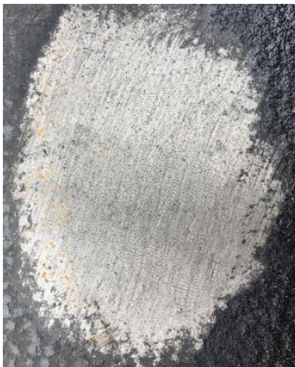
Figura 16 - Amostra com superfície esmerilhada
