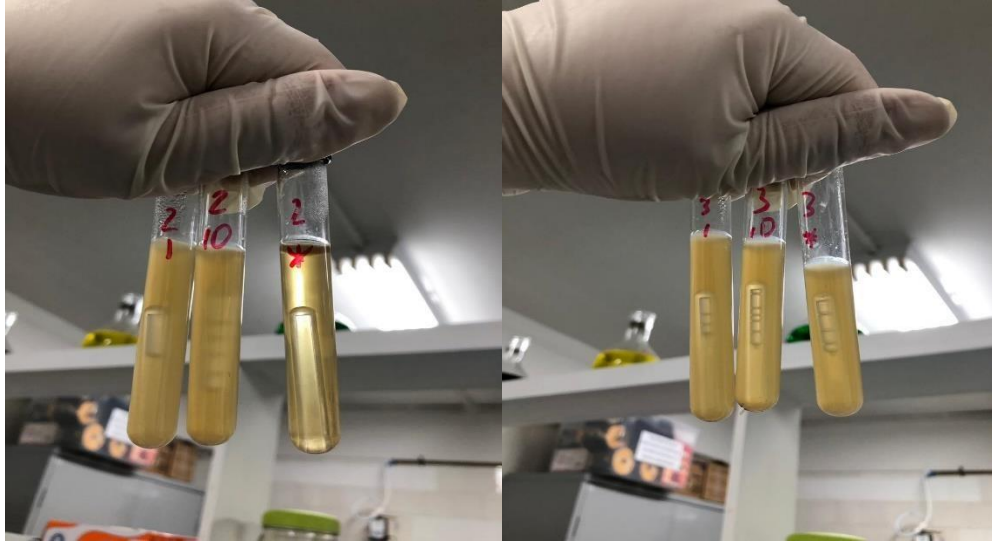
Figura 2. Tubos contendo caldo E.C. apresentando crescimento bacteriano e presença de gás no interior dos tubos de Durham
