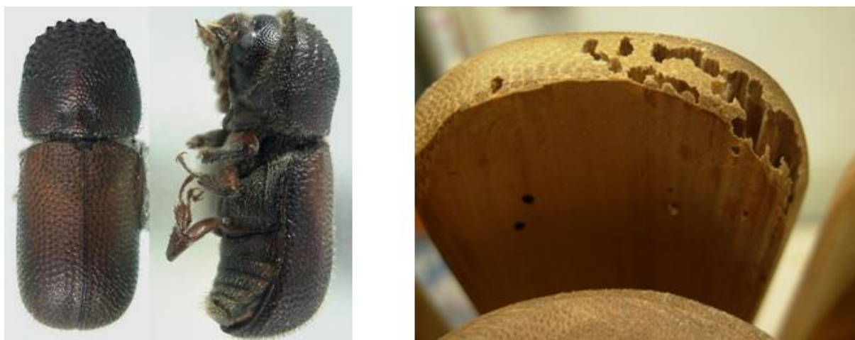
Figura 13 e 14: Broca ( Dinoderus minutus ) e bambu atacado pela broca. Fonte: Bug Guide. 2008 e Bambucraft.net. 2000
