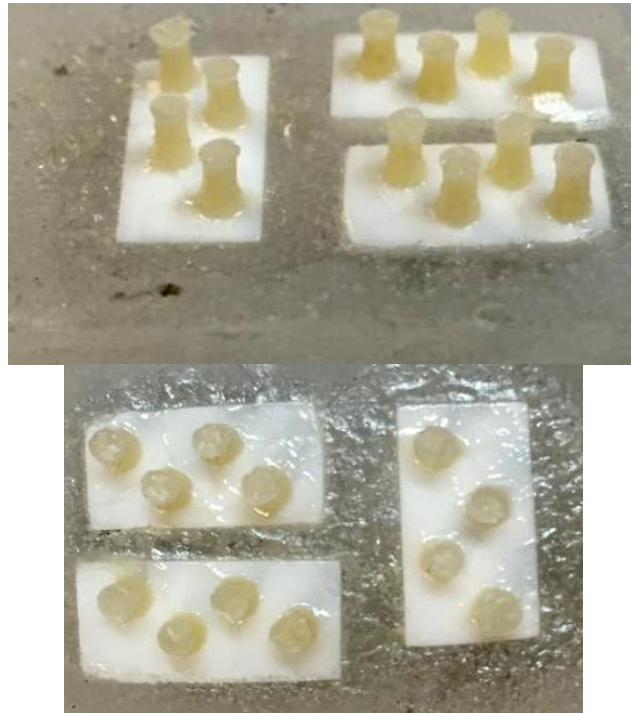
Figura 1- Corpos de prova, composto de cerâmica de dissilicato de lítio, embutida em resina acrílica e cimentados, sobre ela, cilindros de cimento resinoso.
