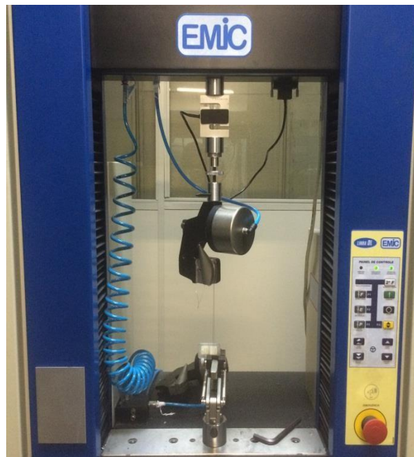
Figura 2- Ensaio de cisalhamento na máquina universal de ensaios.
