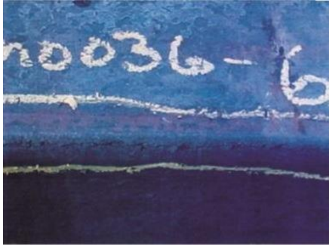
Figura 50: Superfície do tarugo com trinca longitudinal de canto.
