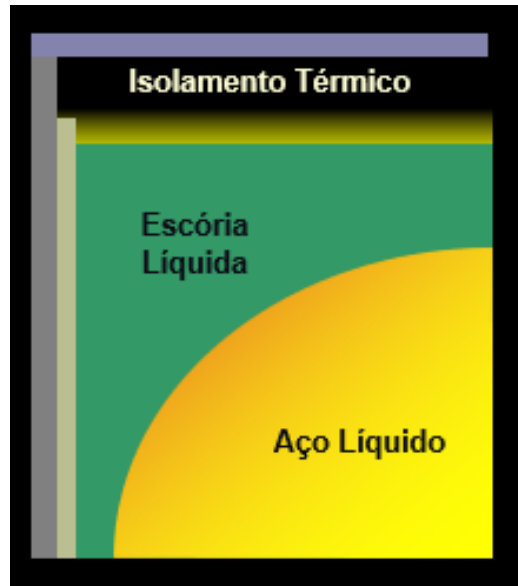
Figura 20: Representação do isolamento térmico pelo fluxante.
