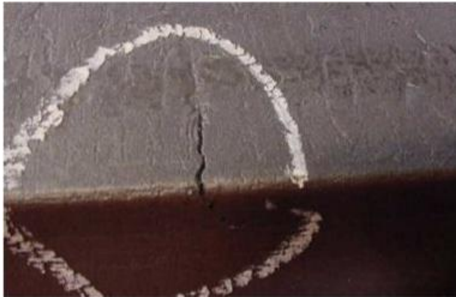
Figura 36: Superfície do tarugo com trinca transversal de canto.
