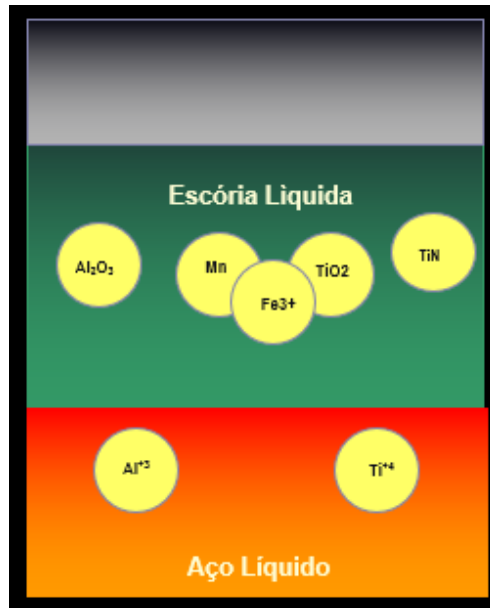
Figura 23: Absorção das inclusões pelo fluxante.
