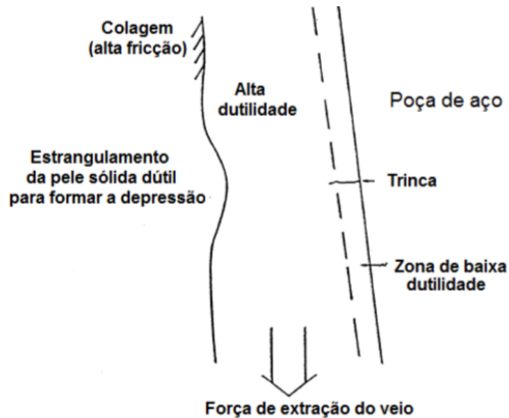
Figura 46: Mecanismos de formação de depressão longitudinal e trincas, em razão de colamento do veio sobre a parede do molde.
