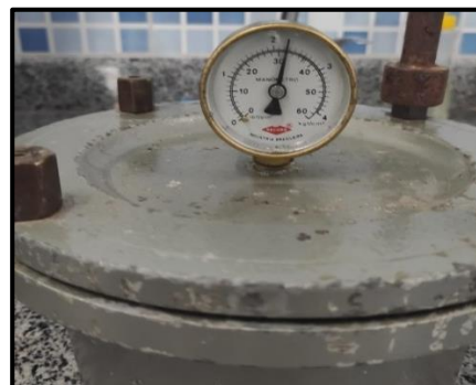
Figura 13: Panela eliminadora de bolhas fechada e elevada a pressão de 30 N.
