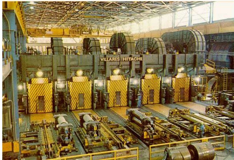
Figura 32 Exemplo real de laminador de tiras a frio. Fonte: Companhia Siderurgica Nacional (2005).
