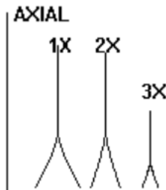
Figura 35- Espectro típico de desalinhamento axial.
