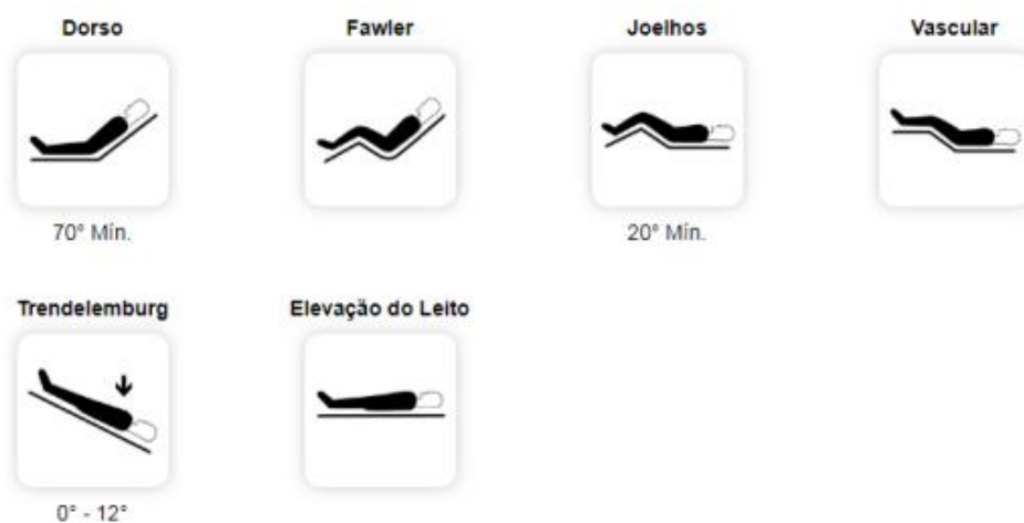
Figura 2 - Movimentos cama Fowler 3 manivelas com elevação de altura.
