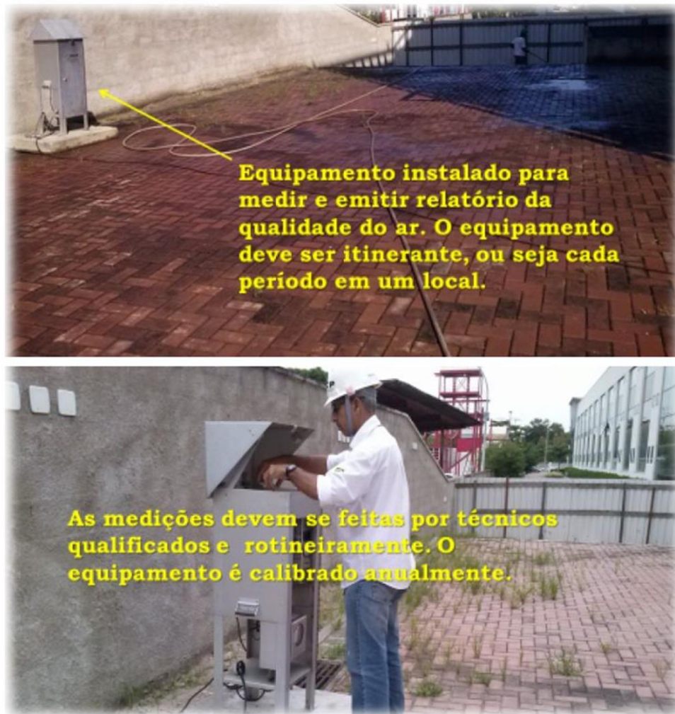
Figura 7- Controle da poluição do ar externo / interno
