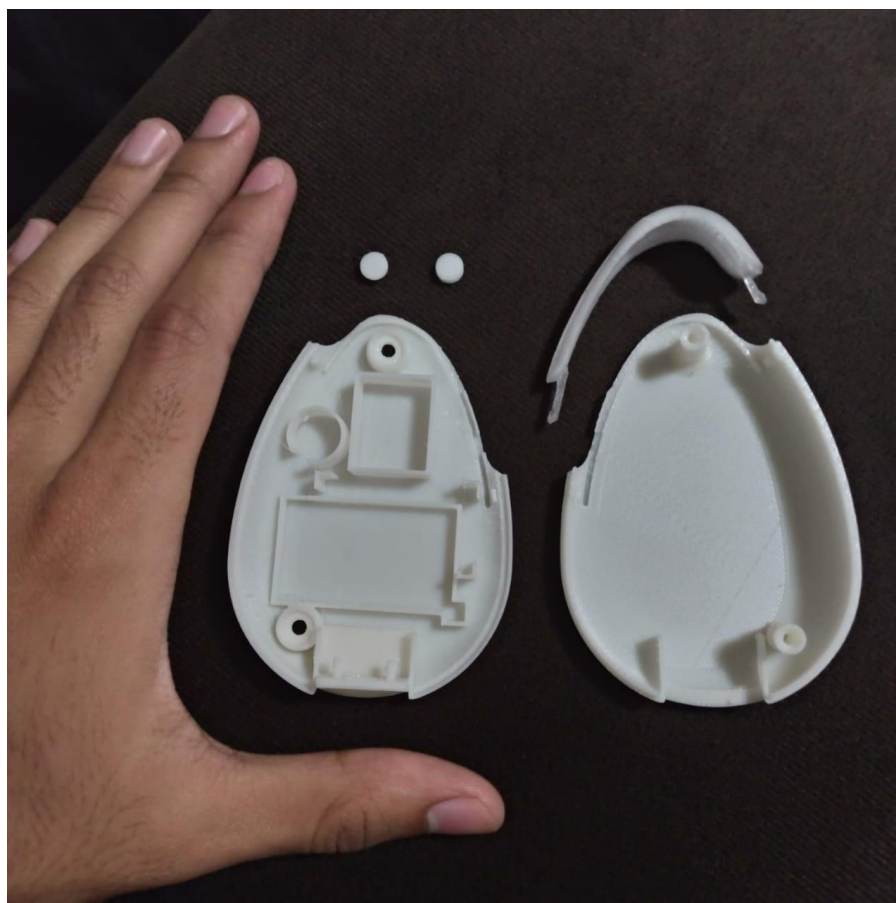
Figura 46 - Dispositivo da Respiração: Impressão 3D - Desmontado
