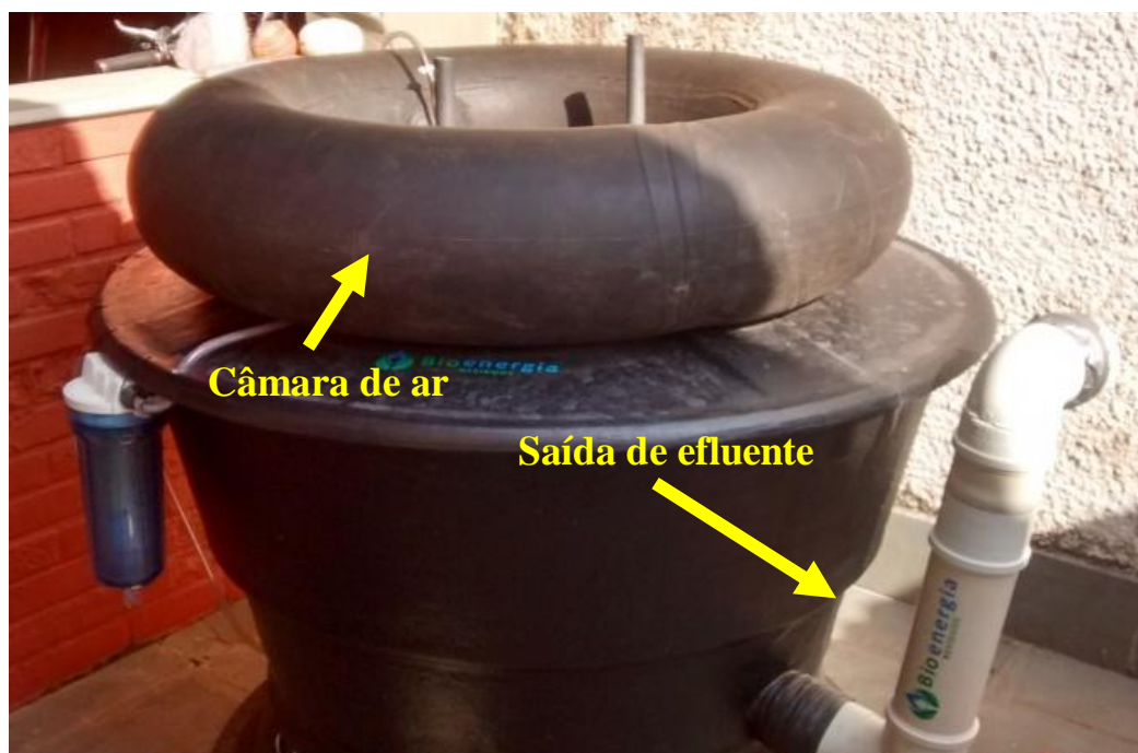
Figura 11: Protótipo biodigestor anaeróbio
