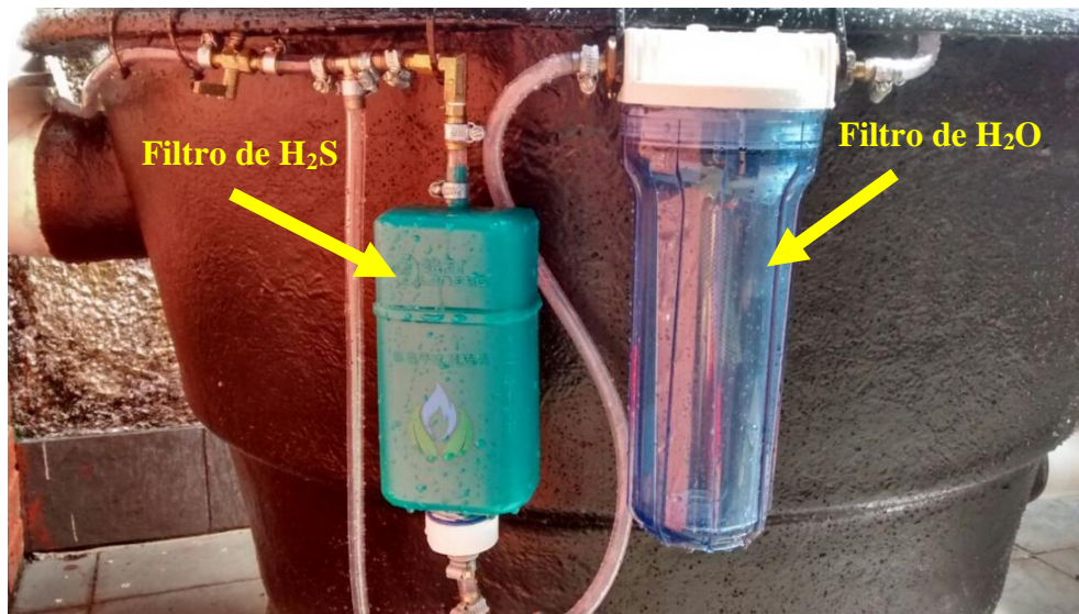
Figura 12: Protótipo biodigestor anaeróbio
