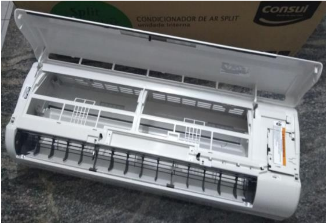
Figura 17: Gabinete interno limpo
