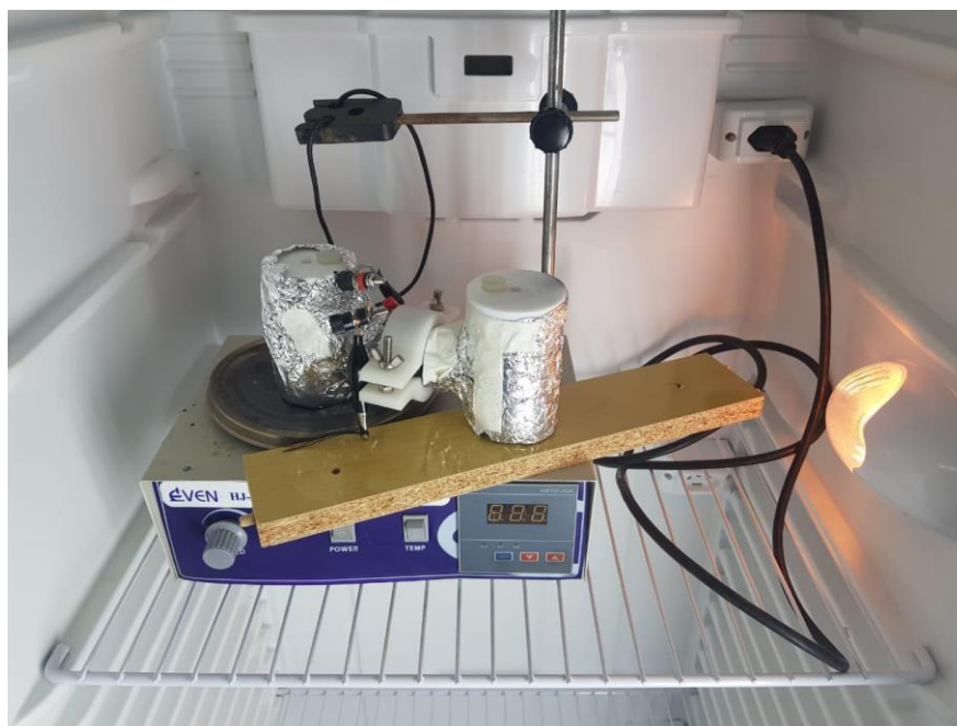
Figura 15 - Sistema de CCM sobre agitador magnético no interior da estufa.
