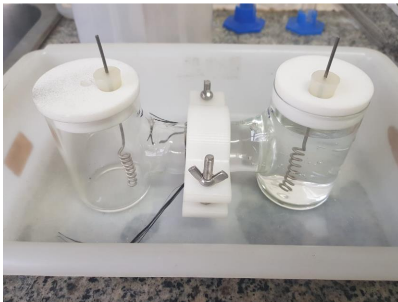
Figura 13 – Montagem da CCM finalizada.
