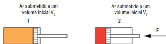
Figura 1. Esquematização da Compressibilidade do Ar
