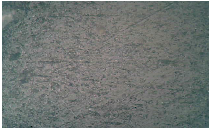
Figura 52 - MO do HIPs Puro (Ampliação, 400)
