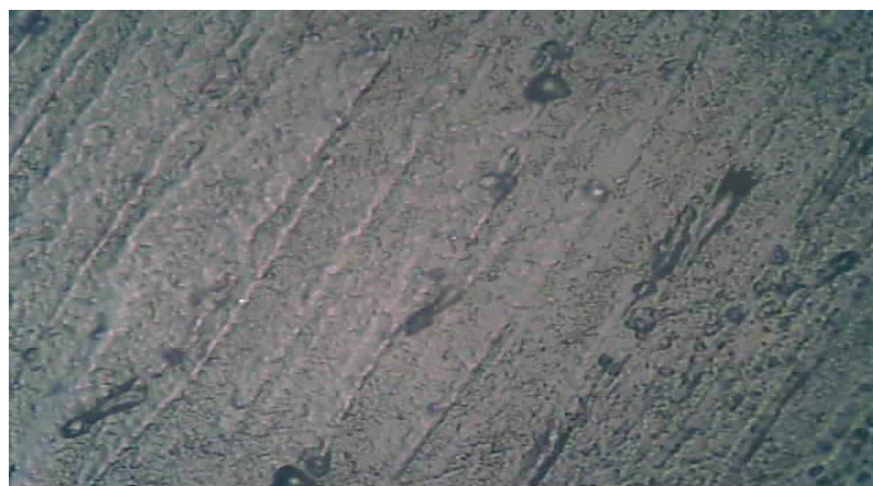
Figura 56 - M0 do ABS Puro (Ampliações 100, 200, 400)
