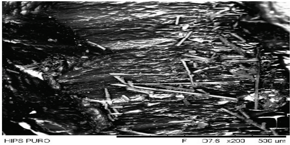
Figura 42 - MEV do HIPs 85/15 (Ampliação, 200)
