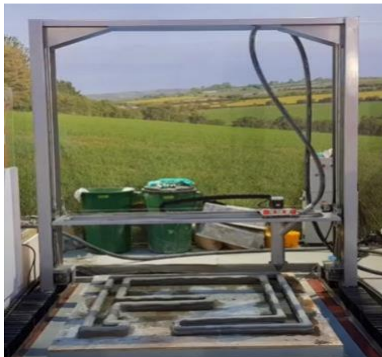
Figura 24 - Impressora da Inovahouse3D em atuação. Fonte: Inovahouse3D, 2019.
