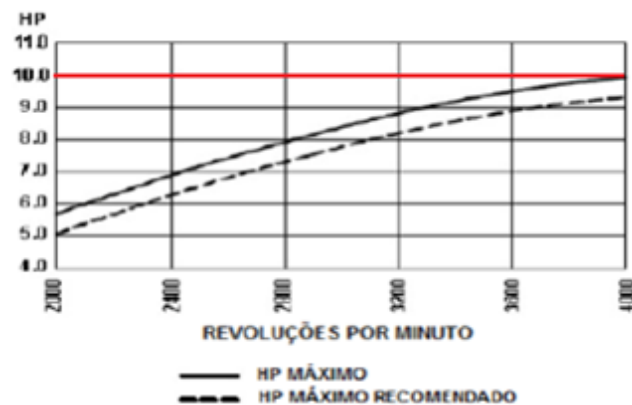
Figura 6 - Gráfico de potência em relação a rotação. Fonte: Briggs e Stratton, 2011
