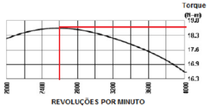
Figura 5 - Gráfico de torque em relação a rotação. Fonte: Briggs & Stratton, 2011.
