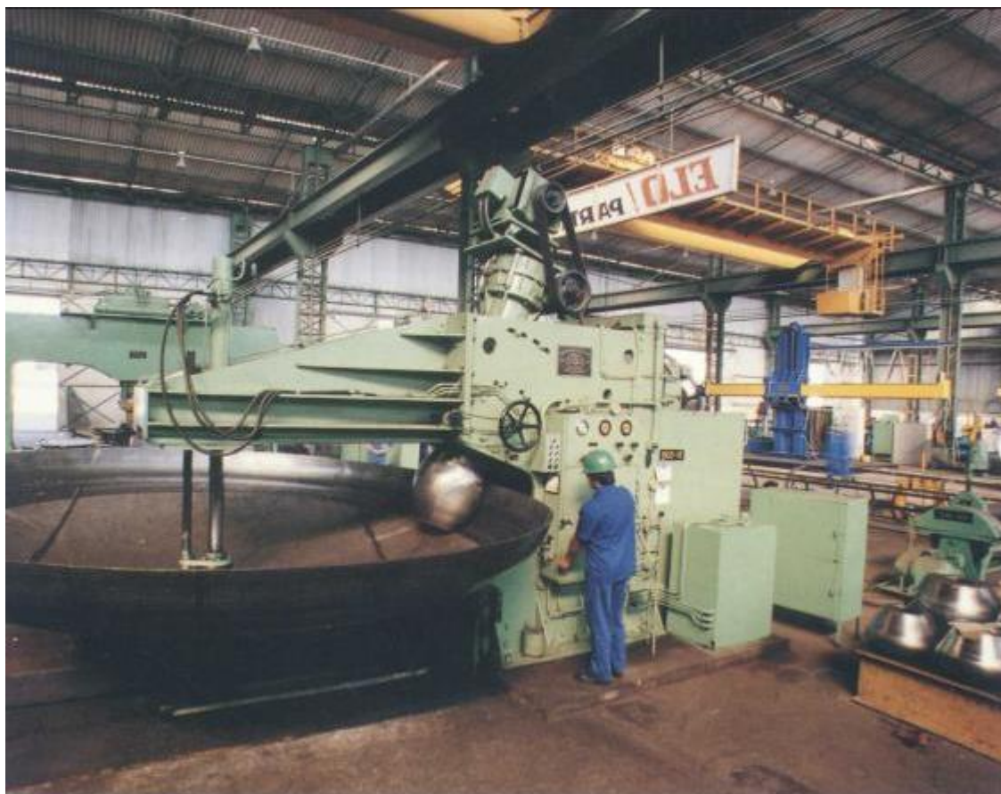
Figura 30 – Processo de rebordeamento. Codismo.
