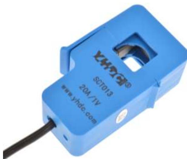
Figura 33 – Sensor de corrente SCT-013-020. (Fonte: FILIPEFLOP, 2018)
