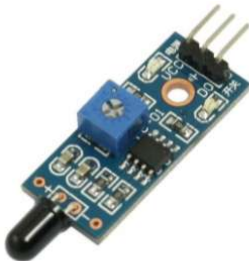
Figura 28 – Sensor Chama Fogo 760 a 1100 nm. (Fonte: ELETROGATE, 2018)
