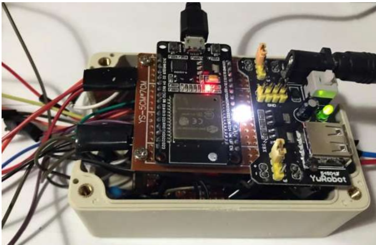
Figura 57 – Caixa com o circuito devidamente montado nas placas de fenolite. (Fonte: Autores, 2018)
