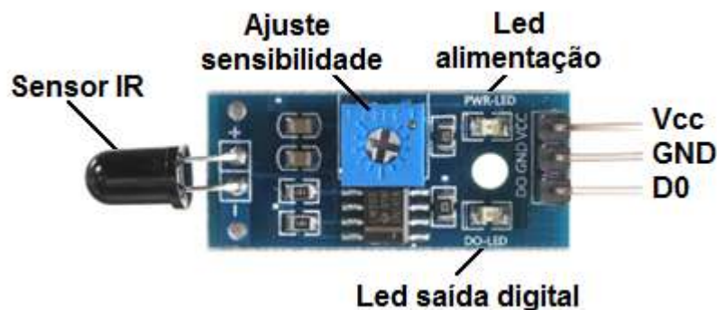
Figura 29 – Sensor Chama Fogo 760 a 1100 nm - parte inferior. (Fonte: Adaptado de FILIPEFLOP, 2015)
