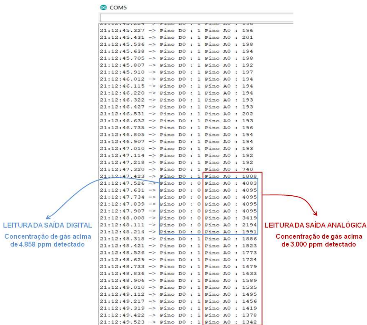
Figura 51 – Leitura das saídas do sensor de gás. (Fonte: Autores, 2018)
