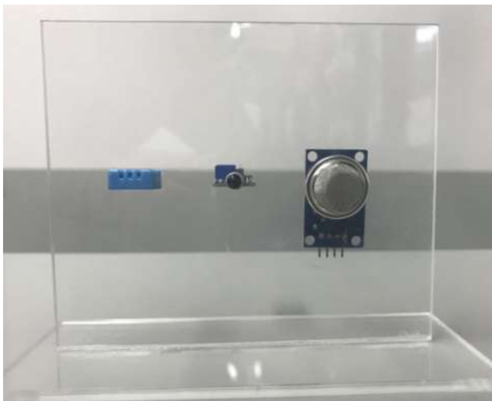
Figura 56 – Placa 2 - Sensores de temperatura e umidade, fogo e gás. (Fonte: Autores, 2018)
