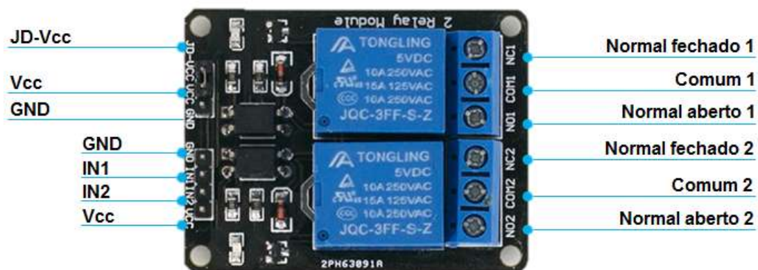
Figura 37 – Pinagem do módulo relé de 2 canais. (Fonte: FILIPEFLOP, 2013)
