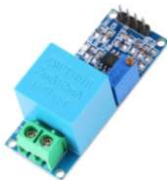
Figura 30 – Sensor de tensão AC 0 a 250Vac ZMPT101B. (Fonte: CURTO CIRCUITO, 2018)
