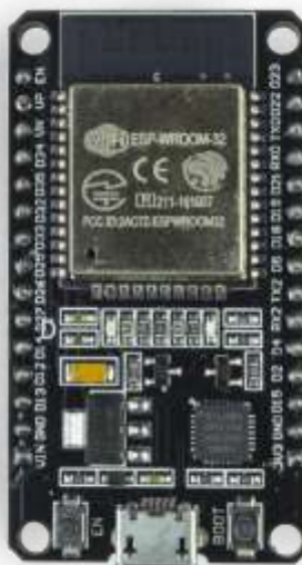
Figura 20 – Node MCU-32S ESP32. (Fonte: ROBOCORE, 2018)
