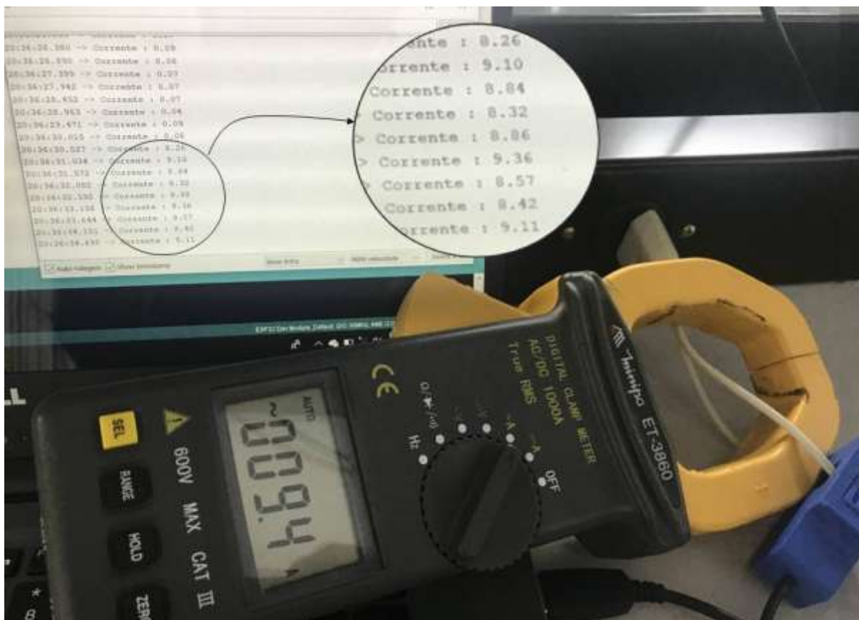
Figura 46 – Comparação dos valores medidos pelo sensor de corrente e alicate amperímetro. (Fonte: Autores, 2018)
