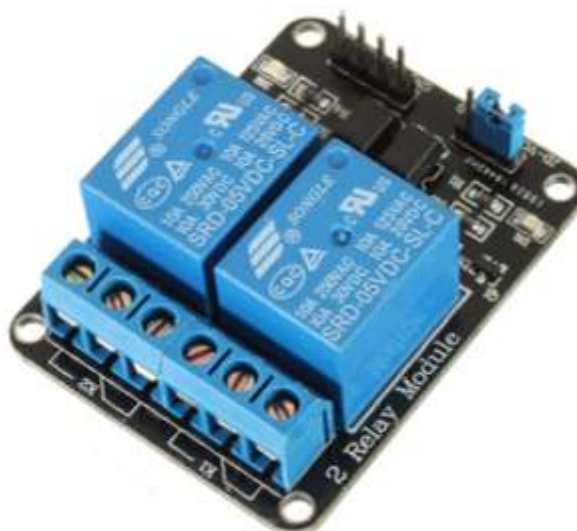
Figura 36 – Módulo relé de 2 canais. (Fonte: FILIPEFLOP, 2018)
