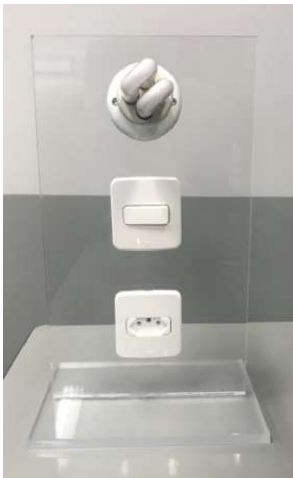
Figura 55 – Placa 1 - Lâmpada, interruptor e tomada. (Fonte: Autores, 2018)
