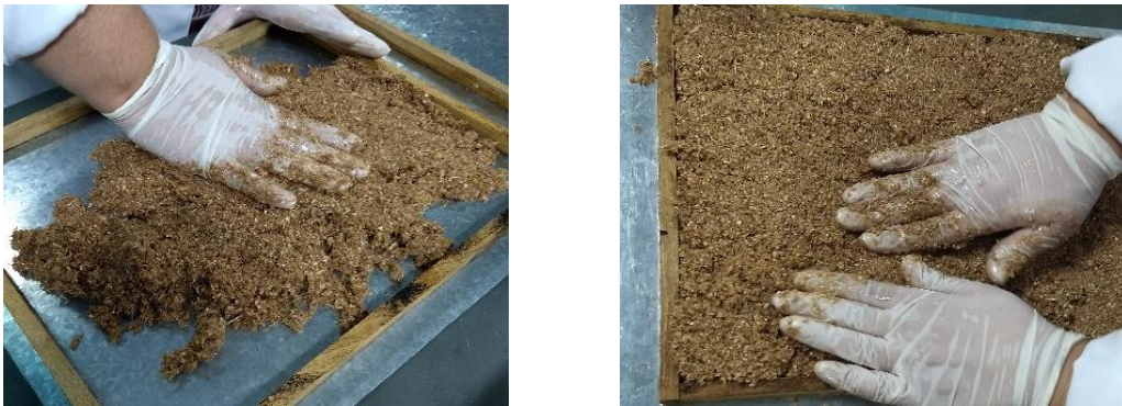
Fotografia 7: Compactação manual dos painéis Fonte: As autoras (2019)
