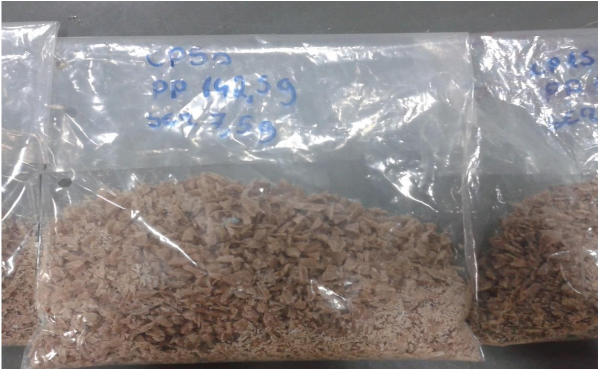
Figura 9: Compósito de polipropileno reforçado com 5% de serragem. Fonte: Os autores.
