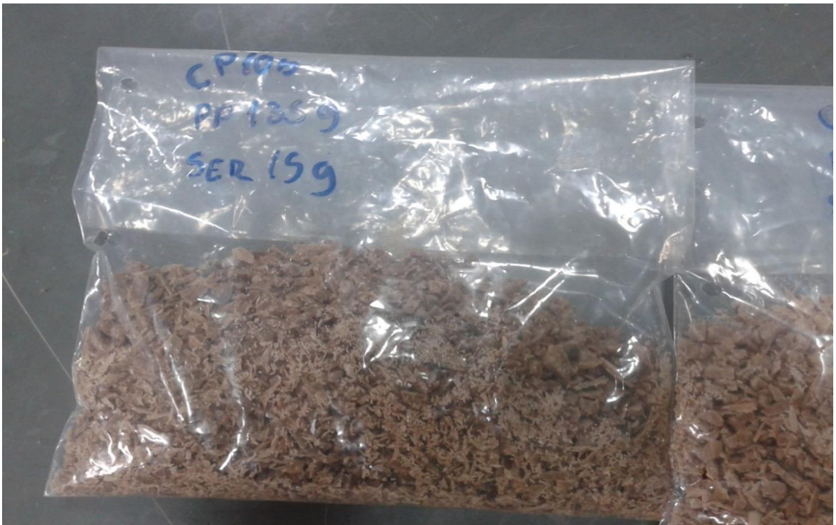
Figura 10: Compósito de polipropileno reforçado com 10% de serragem. Fonte: Os autores.
