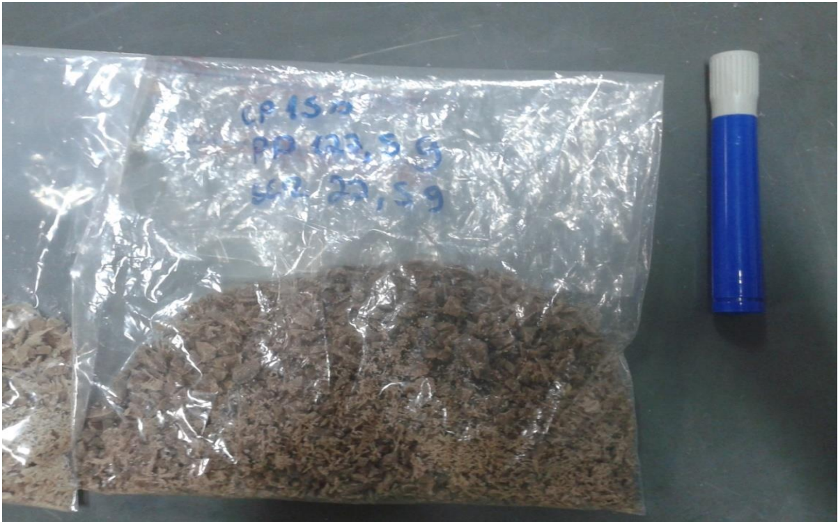
Figura 11: Compósito de polipropileno reforçado com 15% de serragem. Fonte: Os autores.
