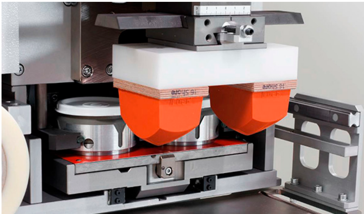
Figura 51 – Método de impressão por Tampografia.
