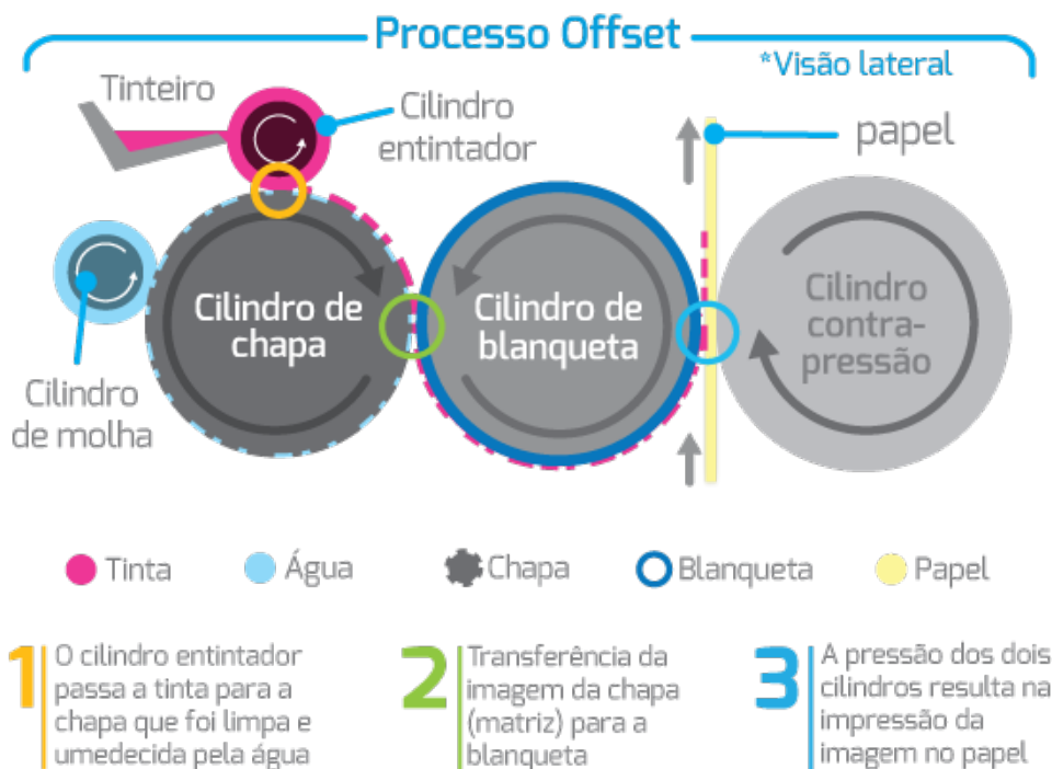
Figura 46 – Método de impressão Offset .
