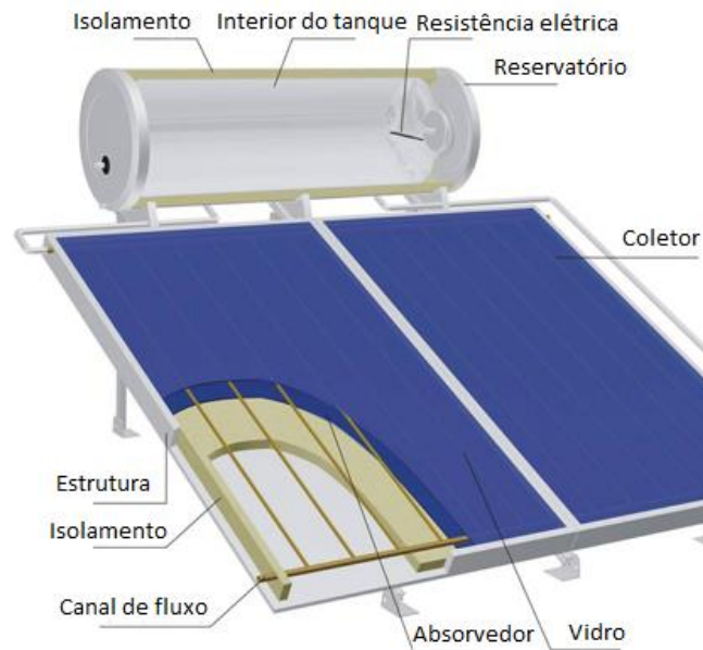
Figura 20: Coletor de placa plana. (HIMIN SOLAR, 2017)
