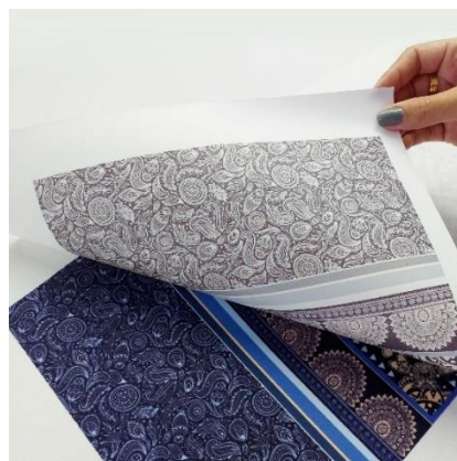
Figura 48: Técnica de estampa através da sublimação.
