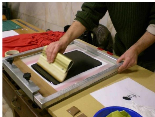
Figura 46: Método de estamparia em serigrafia. Fonte: Mercado Livre.
