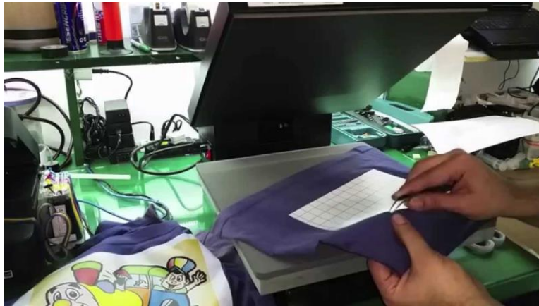
Figura 47: Método “ Transfer ” de estampa.
