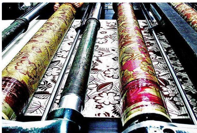
Figura 50: Estamparia através de Cilindro.
