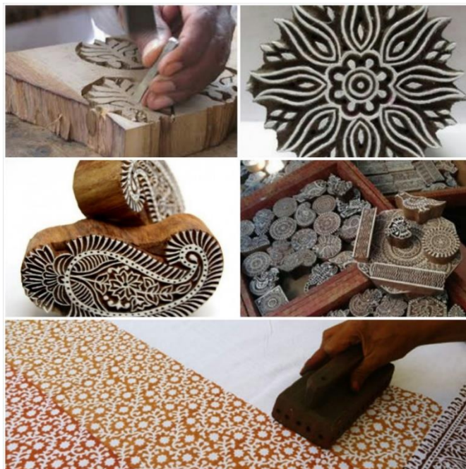
Figura 44: Confeção e Estamparia de tecido com a técnica do Bloco.
