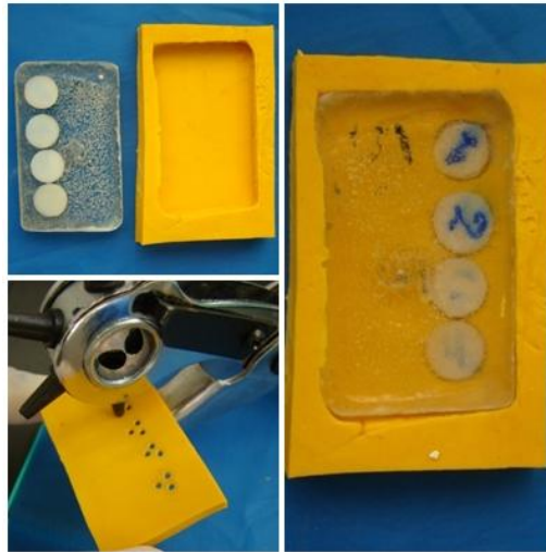
Figura 1 – Amostra embutida, molde de silicone e perfurador de couro, com perfurações de 2 mm de diâmetro Fonte: autoria própria
