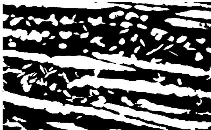
Figura 38: Metalografia aço inoxidável Duplex AISI 2304 com tratamento térmico a 1100°C 400x após tratamento no IMAGEJ.
