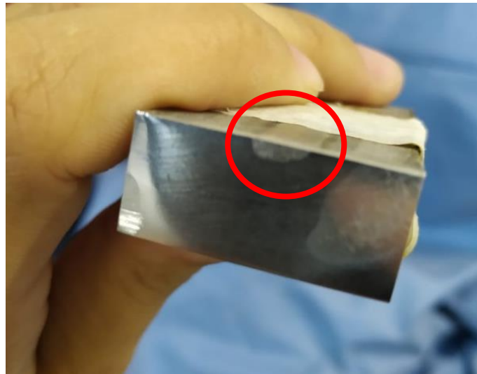
Figura 44: Profundidade do cordão de solda no corpo de prova soldado a baixa energia de soldagem (0,5 kJ/mm).
