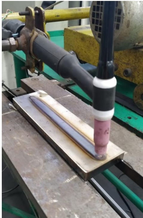
Figura 42: Corpo de prova após soldagem com alta energia de soldagem (2,0kJ/mm).
