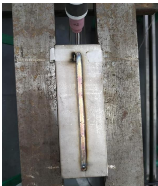
Figura 41: Corpo de prova após soldagem com baixa energia de soldagem (0,5kJ/mm).
