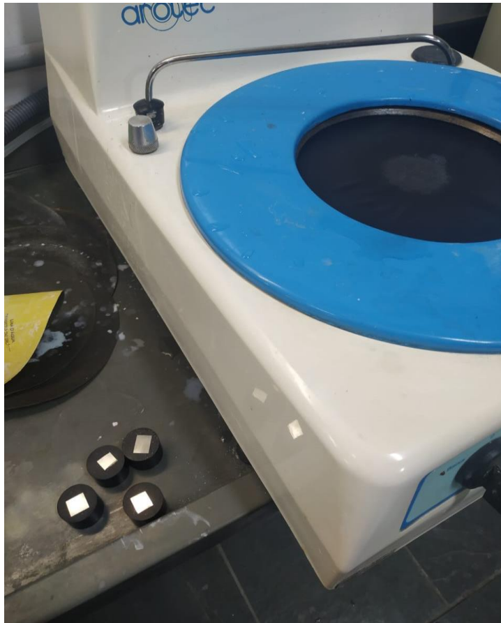
Figura 28: Amostras embutidas a esquerda e a direita a lixadeira manual utilizada.
