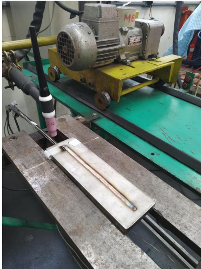
Figura 25: Equipamento para soldagem automática
