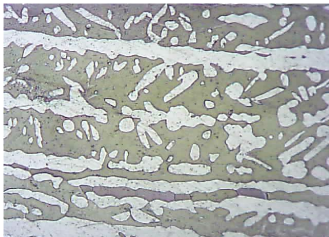
Figura 50: Aço duplex 1h30 no forno a 1100°C aumento de 400x
