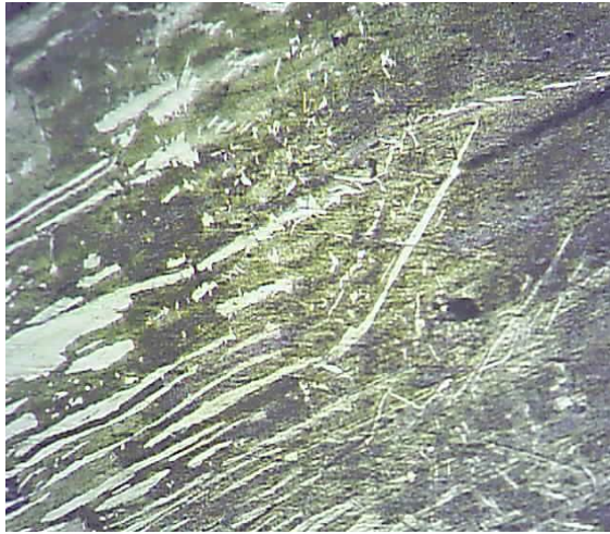
Figura 55: Aço inoxidável duplex AISI 2304 aporte 2,0KJ/mm aumento de 100x.
