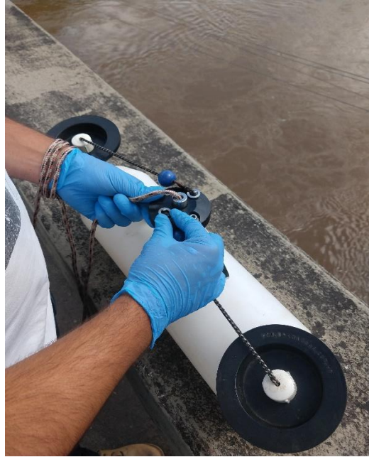
Figura 17: Preparação da garrafa de Van Dorn Fonte: Os próprios autores
