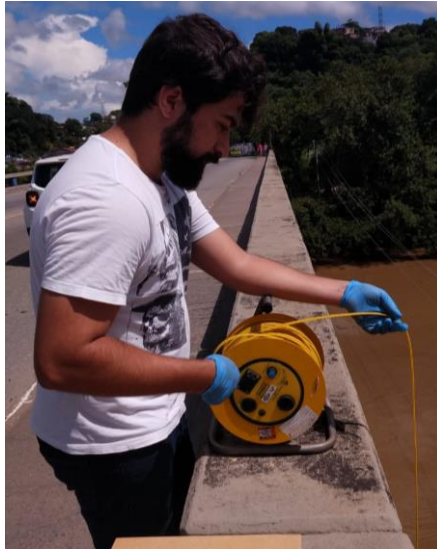
Figura 15: Leitura do nível d'água e profundidade (local 1). Fonte: Os próprios autores
