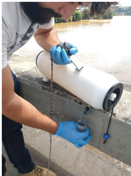
Figura 19: Transferência da amostra para frasco de leitura do multiparâmetro. Fonte: Os próprios autores
