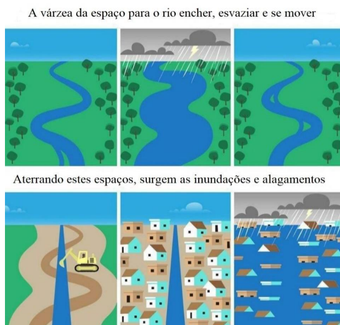
Figura 2– Conseqüências da retificação dos rios e construção nas planícies de inundação.
