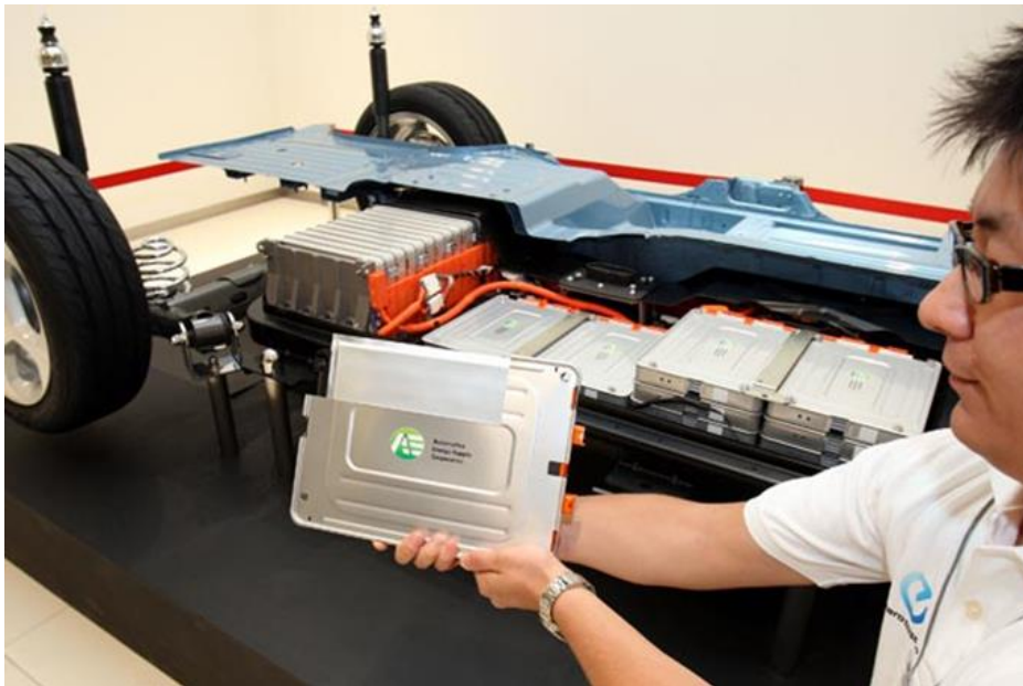
Figura 8 - Configuração das Baterias de Lítio-Íon no Nissan Leaf.
