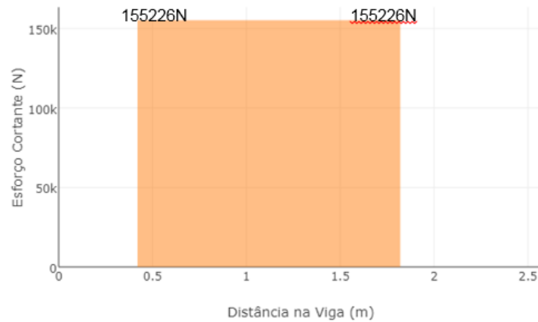
Figura 43 – Diagrama esforço cortante – Viga Online.
