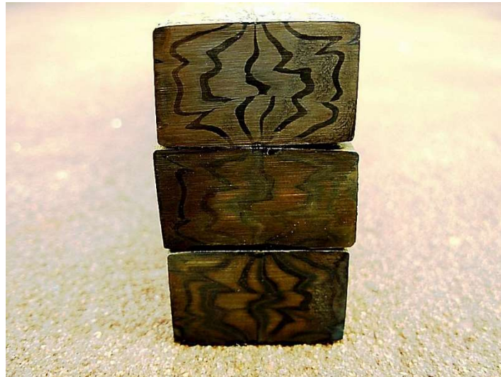
Figura 7 - Desenho de aço damasco, e preparação para multiplicação de camadas
