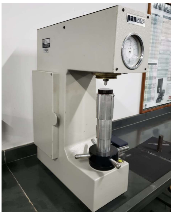
Figura 30 - Durômetro, equipamento utilizado no ensaio de dureza
