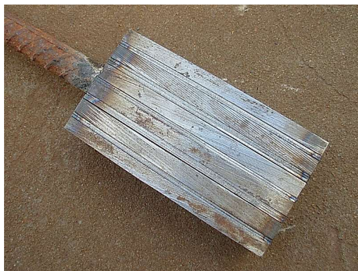
Figura 6 - Aço preparado para a produção do Aço Damasco
