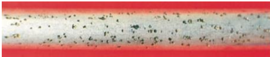
Figura 16 - Tubo de aço inoxidável AISI 304 com corrosão por pite.
