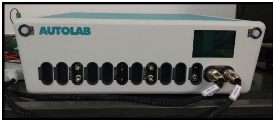
Figura 39 - Equipamento Autolab, modelo PGSTAT302N.
