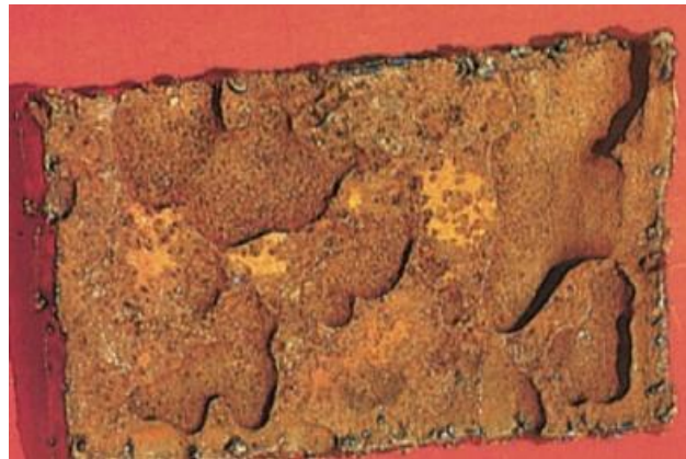
Figura 14 - Trecho de chapa com corrosão em placas.
