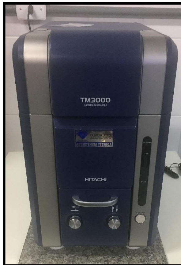
Figura 36 - MEV, Marca HITACHI modelo TM3000
